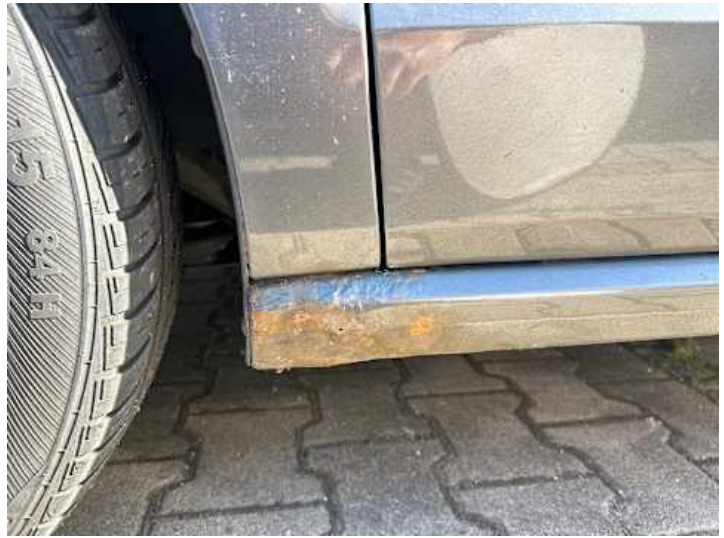
Schweller links (Rost)
