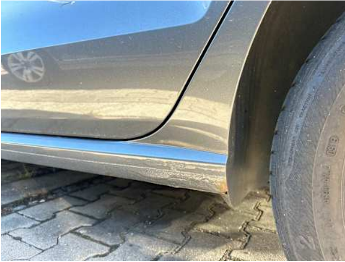
Schweller links (Rost)
