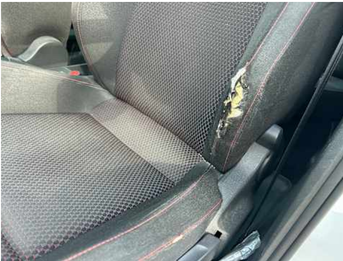
Innenraum (Verschleiß, Diverse Schäden)
