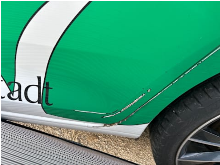
Türe hinten links (Delle, Kratzer, Lackschaden)
