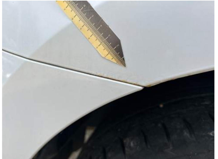
Seitenteil hinten rechts (Rost)
