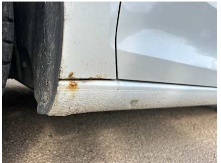
Schweller links (Rost)
