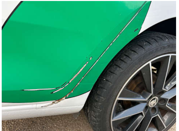
Seitenteil hinten links (Kratzer, Delle, Rost)
