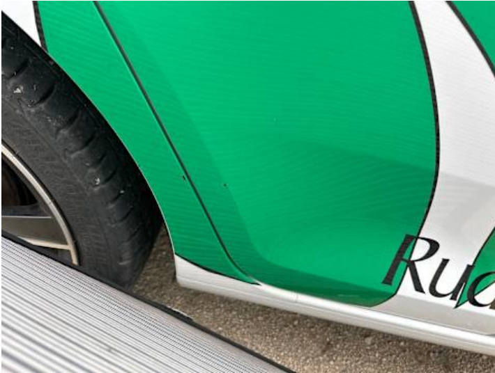
Türe hinten rechts (Delle, Kratzer)
