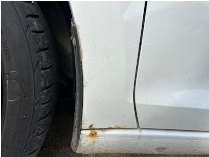
Kotflügel vorne links (Rost)
