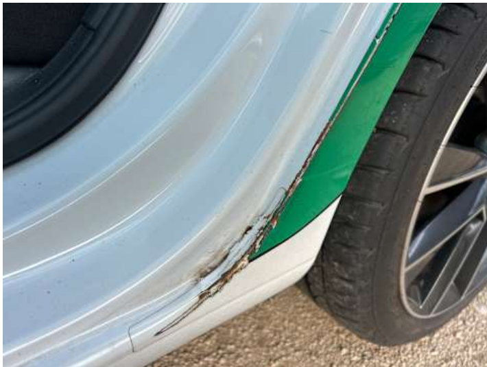
Seitenteil hinten links (Kratzer, Delle, Rost)
