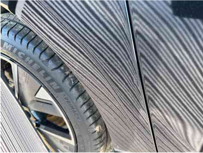
Seitenteil hinten rechts (Delle, Unsachgemäß instand gesetzt)
