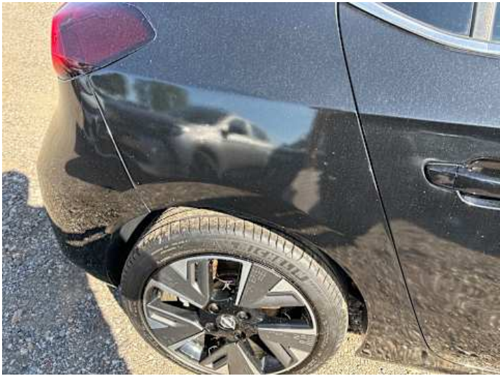
Seitenteil hinten rechts (Delle, Unsachgemäß instand gesetzt)
