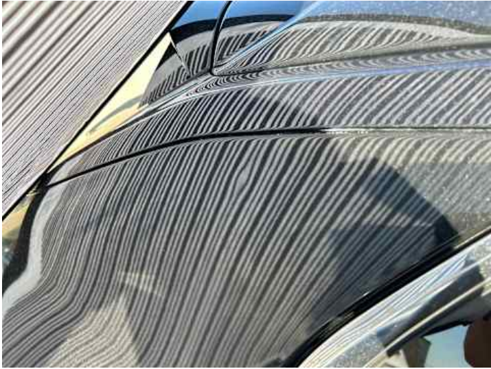
Seitenteil hinten rechts (Delle, Unsachgemäß instand gesetzt)
