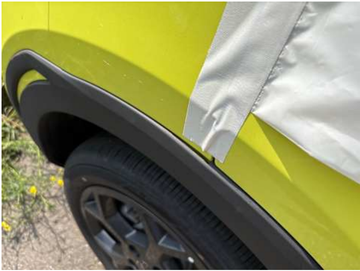
Seitenteil hinten rechts (Spaltmaße ungenau)
