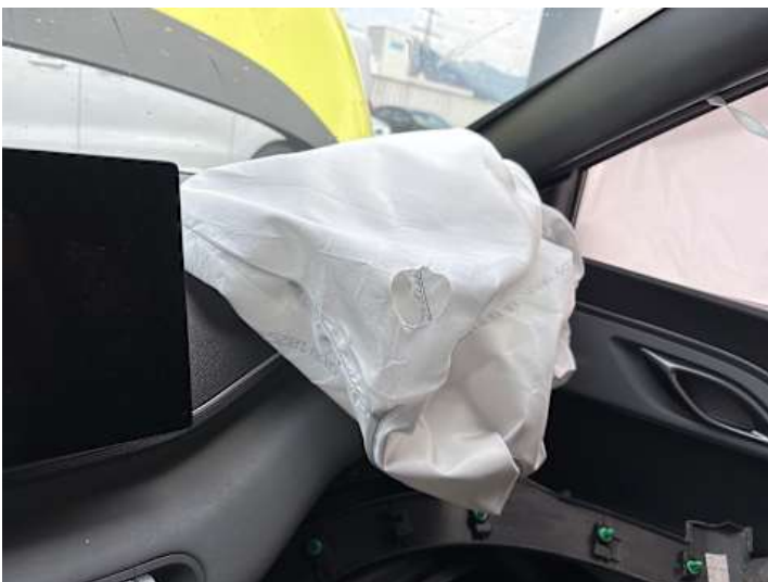
Innenraum (Airbag offen, Riss/Bruch, Anderer Schaden): Gurtspanner ausgelöst
