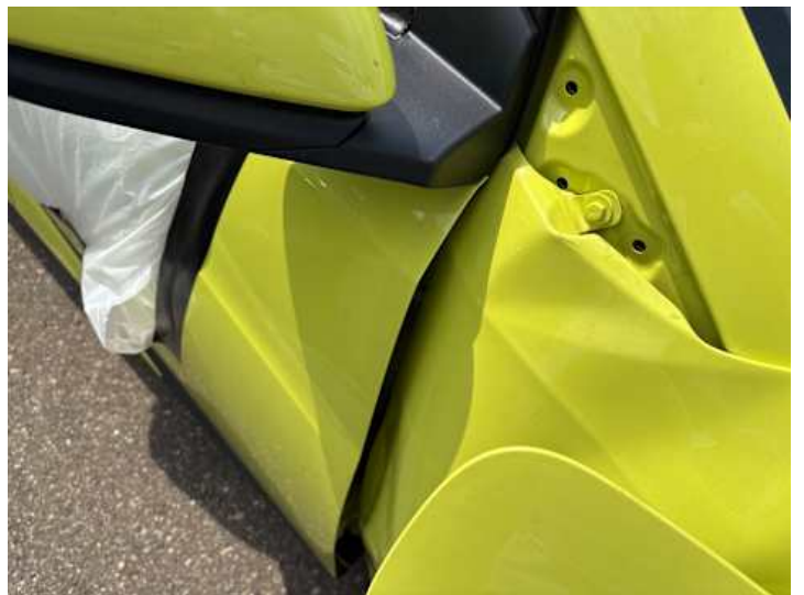
Beifahrertür (Kratzer, Spaltmaße ungenau)
