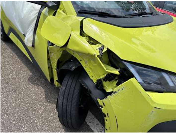
Kotflügel vorne rechts (Verformung, Lackschaden, Riss/Bruch)
