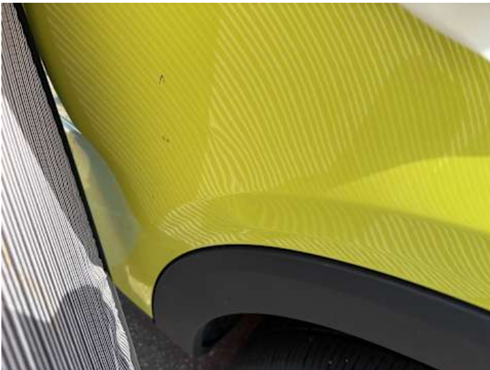
Türe hinten links (Verformung)
