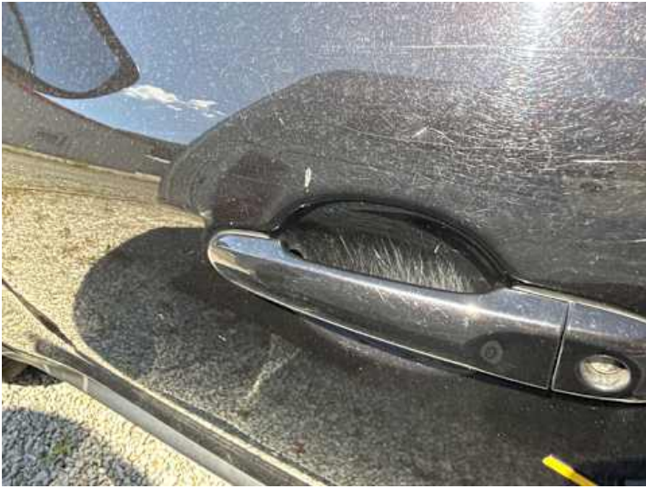
Fahrtür (Lackschaden, Kratzer)
