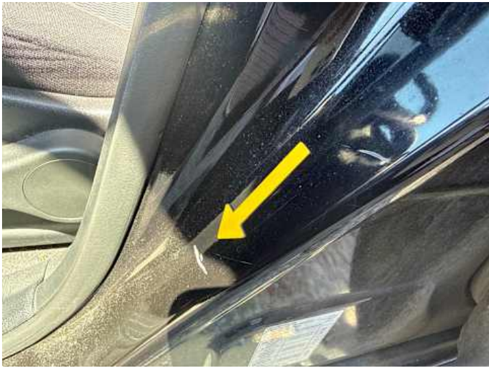
Schweller links (Lackschaden)
