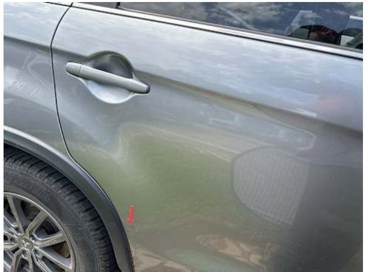
Türe hinten rechts (Verformung, Kratzer)
