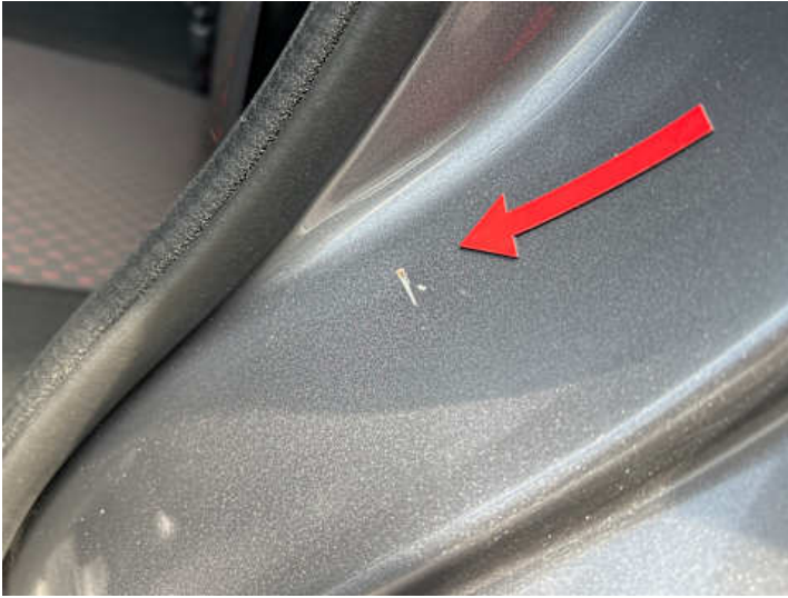
Seitenteil hinten links (Lackschaden)
