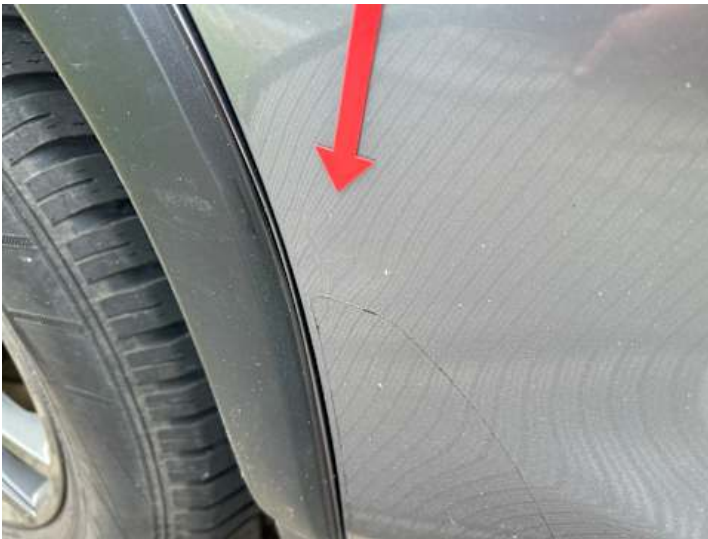
Türe hinten rechts (Verformung, Kratzer)
