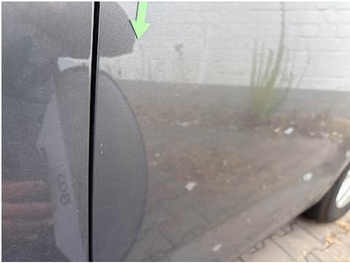
Türe hinten links (Kratzer)
