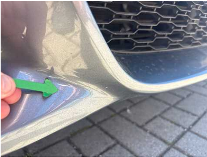
Stoßstange vorne (Riss/Bruch)
