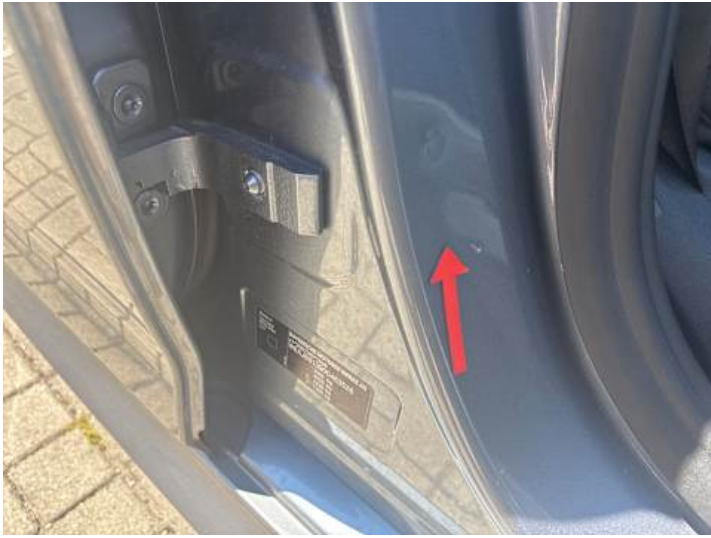
Schweller rechts (Kratzer, Delle)
