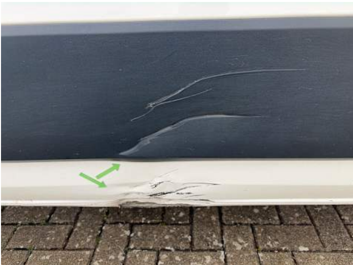
Türe hinten rechts (Kratzer, Lackschaden, Verformung)
