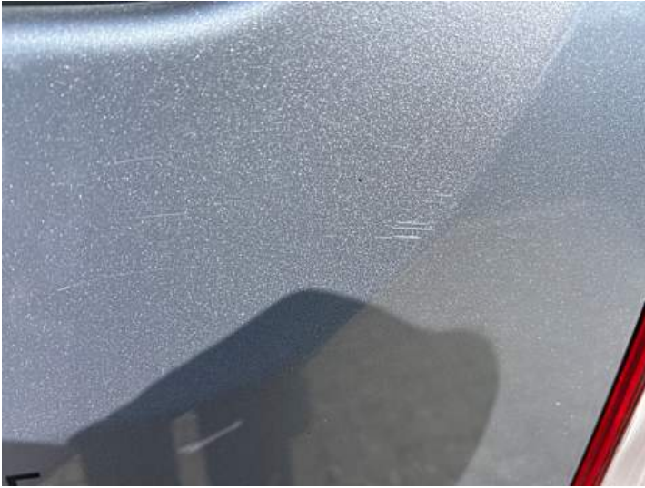
Heckklappe (Kratzer, Lackschaden)
