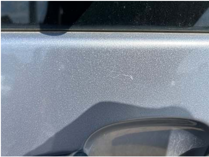
Heckklappe (Kratzer, Lackschaden)
