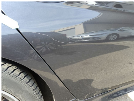
Tür / Hinten Rechts / Delle
