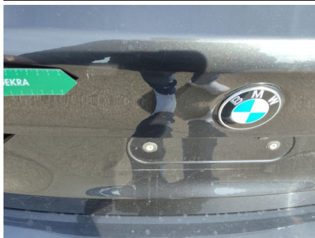
Heckklappe / Kofferraumtür / - / Kratzer
