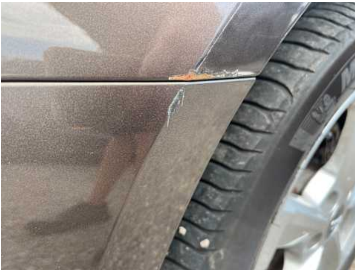
Stoßstange vorne (Lackschaden, Kratzer)
