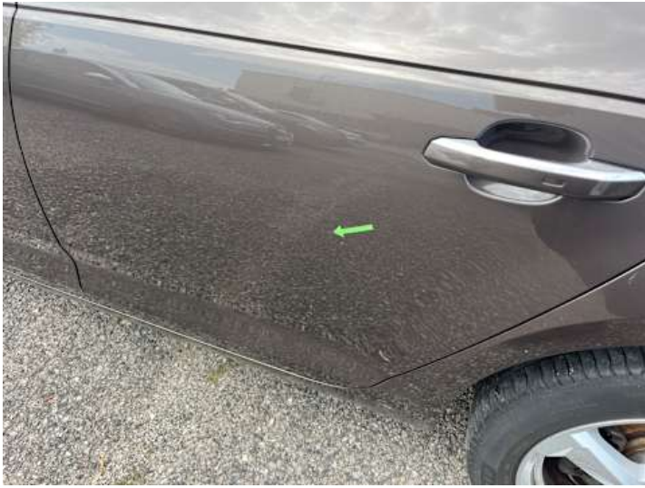
Türe hinten links (Lackschaden, Delle)
