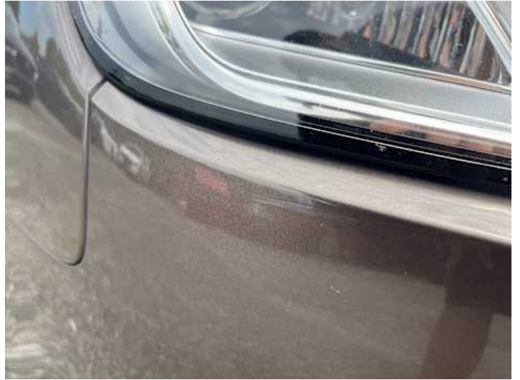
Stoßstange vorne (Lackschaden, Kratzer)
