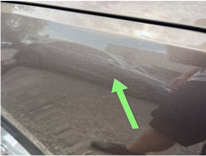
Kotflügel vorne links (Lackschaden, Kratzer, Rost)
