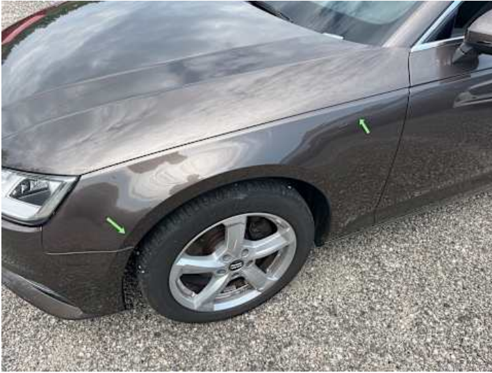
Kotflügel vorne links (Lackschaden, Kratzer, Rost)
