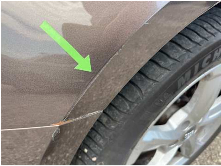
Kotflügel vorne links (Lackschaden, Kratzer, Rost)
