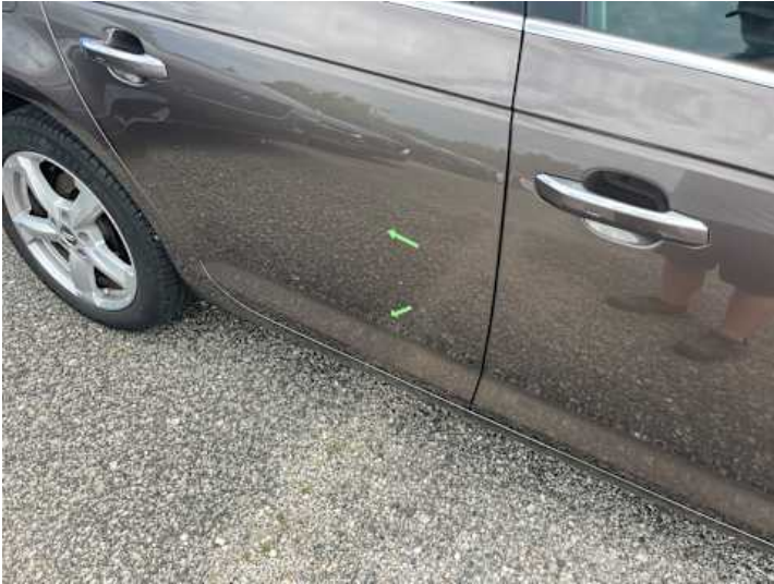
Türe hinten rechts (Lackschaden, Delle)
