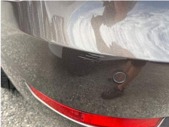
Stoßstange hinten (Lackschaden, Kratzer)
