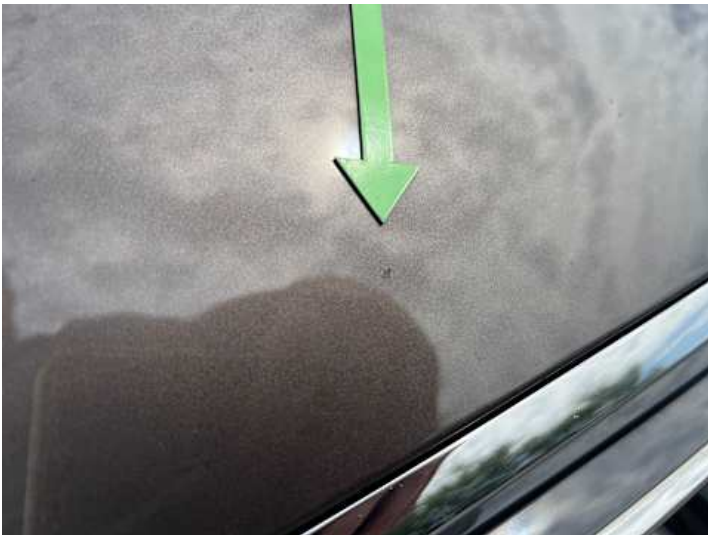
Motorhaube (Lackschaden, Steinschlag)
