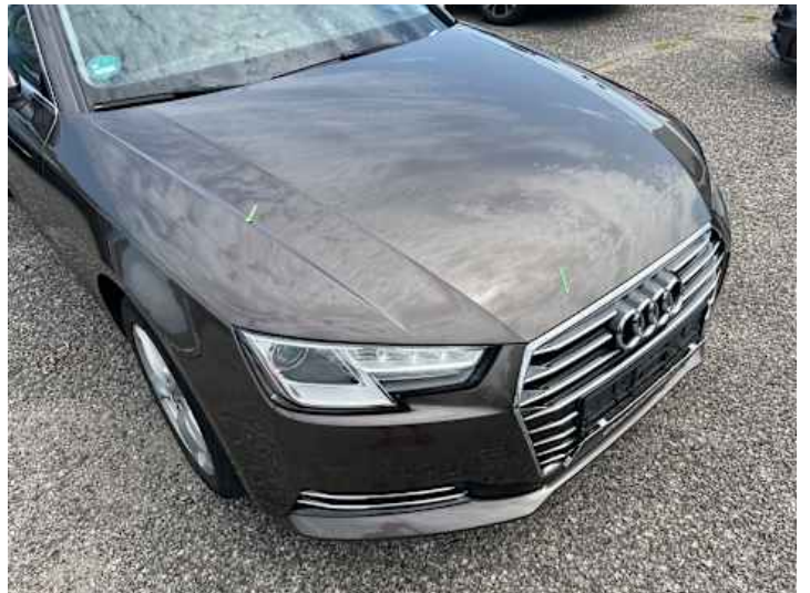
Motorhaube (Lackschaden, Steinschlag)
