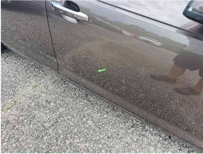
Beifahrertür (Delle, Lackschaden)
