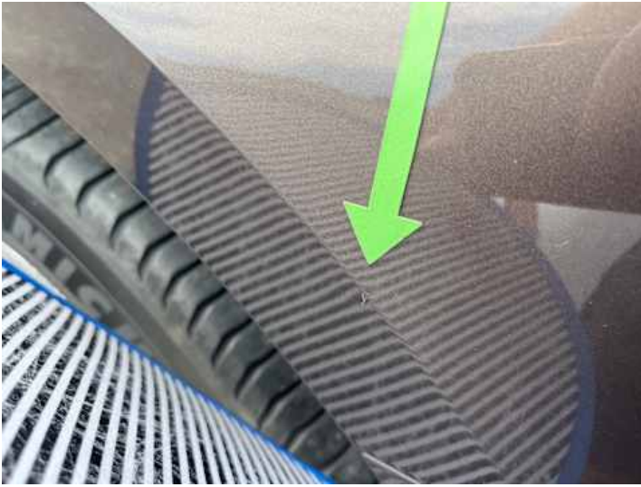
Seitenteil hinten links (Lackschaden, Kratzer, Delle)
