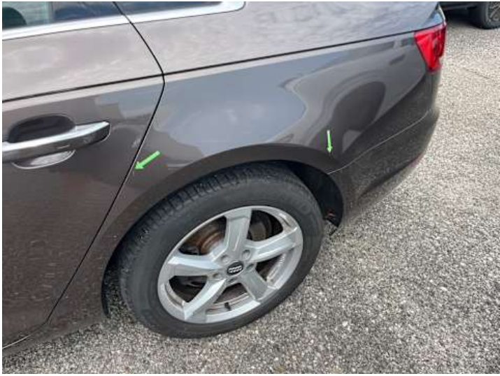
Seitenteil hinten links (Lackschaden, Kratzer, Delle)
