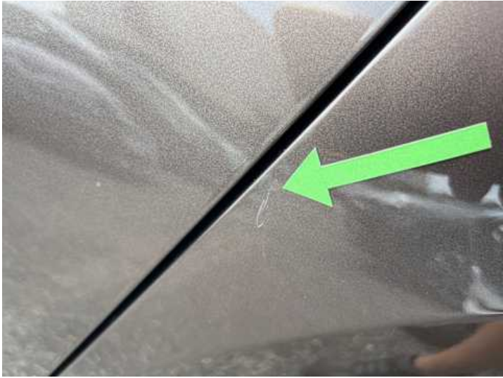
Seitenteil hinten links (Lackschaden, Kratzer, Delle)
