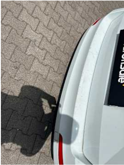
Stoßstange hinten (Kratzer, Spaltmaße ungenau)
