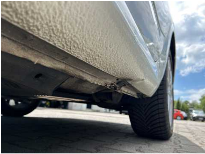
Schweller links (Verformung)
