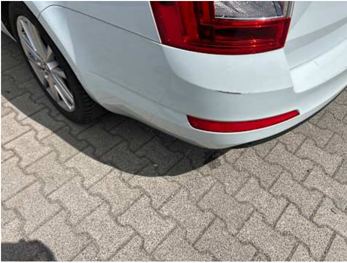
Stoßstange hinten (Kratzer, Spaltmaße ungenau)
