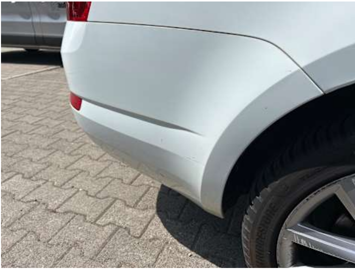
Stoßstange hinten (Kratzer, Spaltmaße ungenau)
