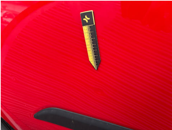
Türe hinten rechts (Delle)
