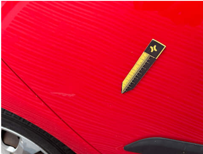
Türe hinten rechts (Delle)
