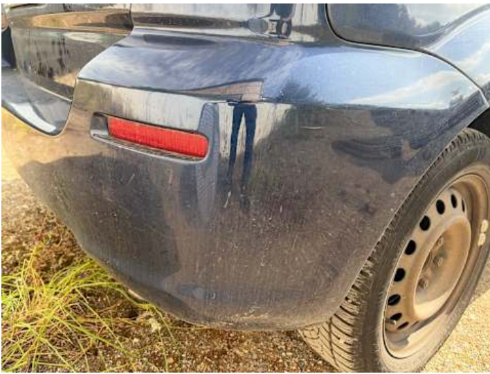
Stoßstange hinten (Lackschaden, Kratzer)
