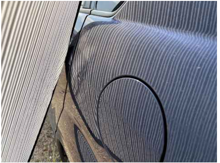
Seitenteil hinten links (Delle)
