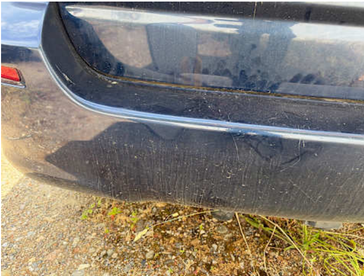
Stoßstange hinten (Lackschaden, Kratzer)
