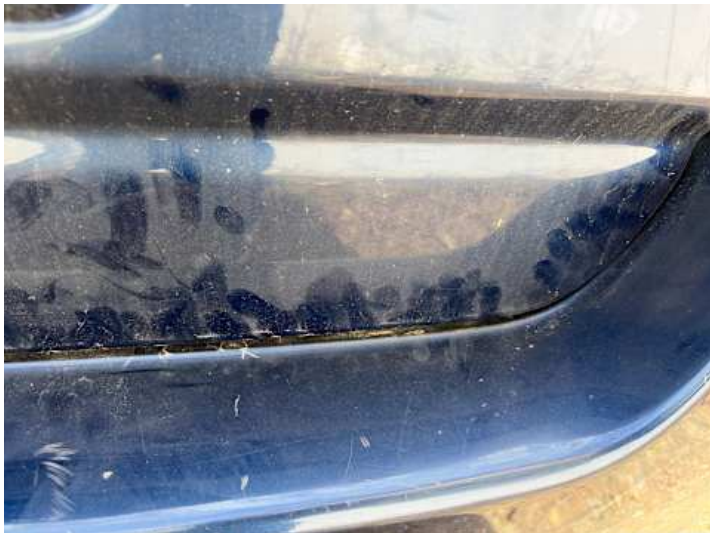
Heckklappe (Lackschaden, Kratzer)
