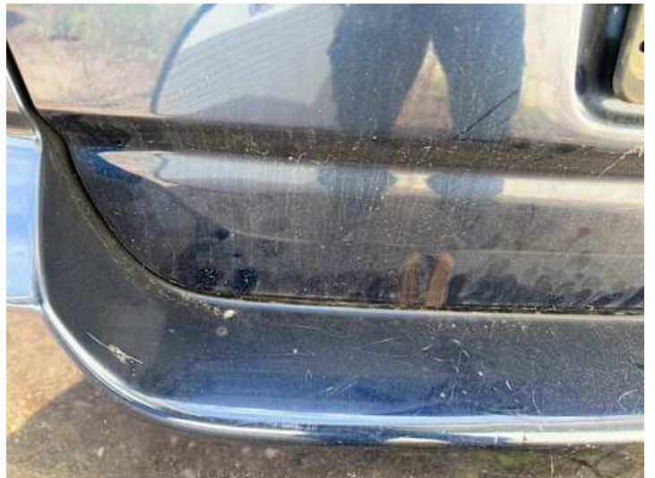
Heckklappe (Lackschaden, Kratzer)
