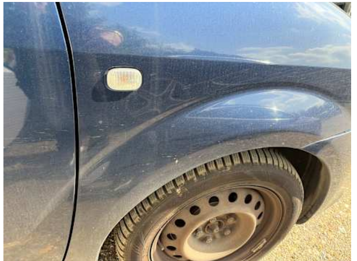
Kotflügel vorne rechts (Lackschaden, Kratzer)
