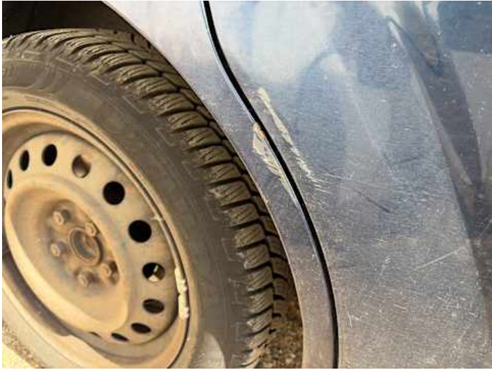
Seitenteil hinten rechts (Lackschaden, Kratzer, Rost)
