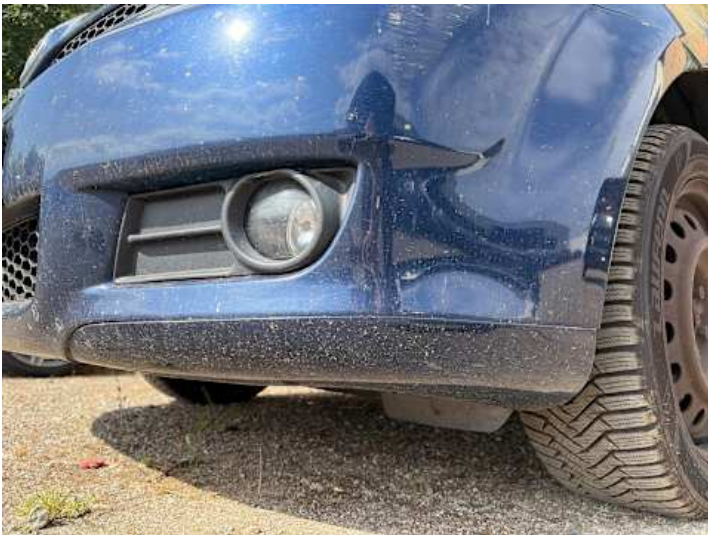
Stoßstange vorne (Lackschaden, Kratzer)
