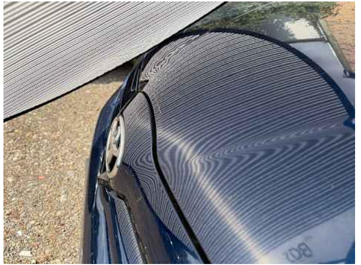
Motorhaube (Delle, Verformung)
