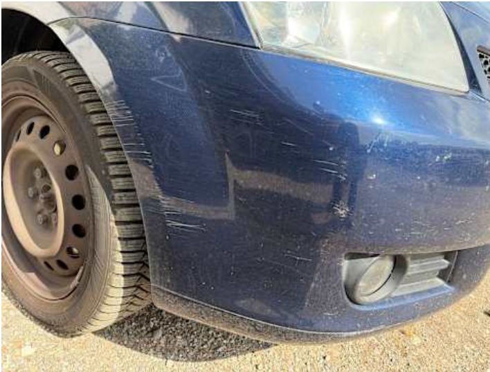
Stoßstange vorne (Lackschaden, Kratzer)
