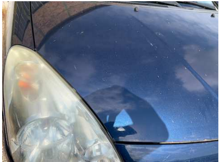
Motorhaube (Lackschaden, Kratzer, Steinschlag)
