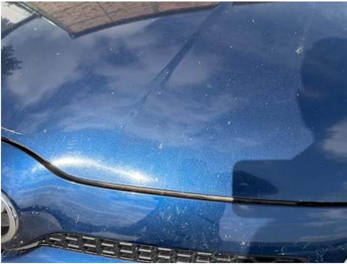
Motorhaube (Lackschaden, Kratzer, Steinschlag)
