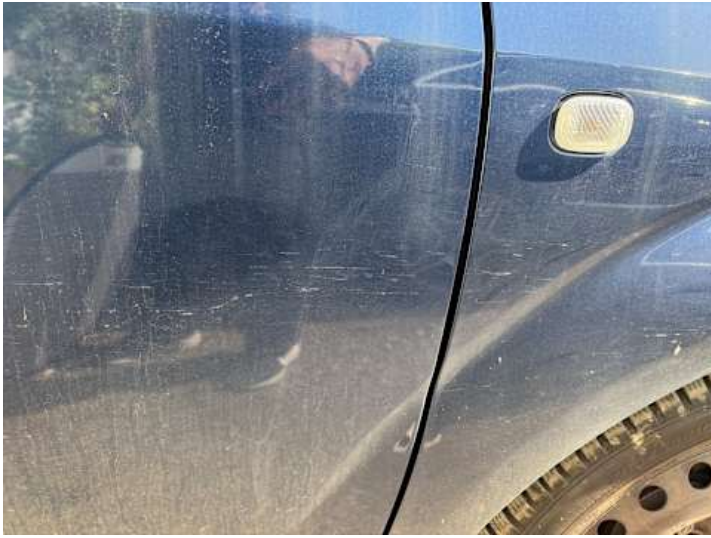
Beifahrertür (Lackschaden, Kratzer)
