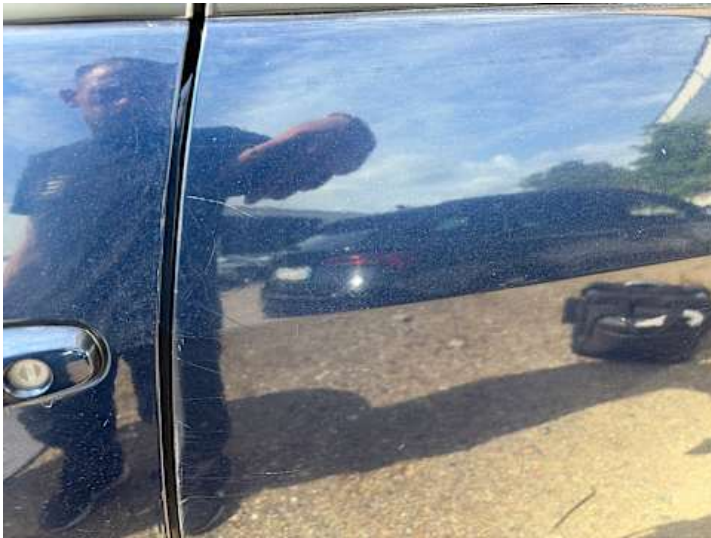
Türe hinten links (Lackschaden, Kratzer)
