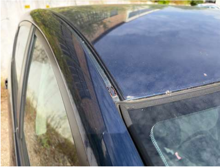
Dach (Anderer Schaden): Leisten fehlen
