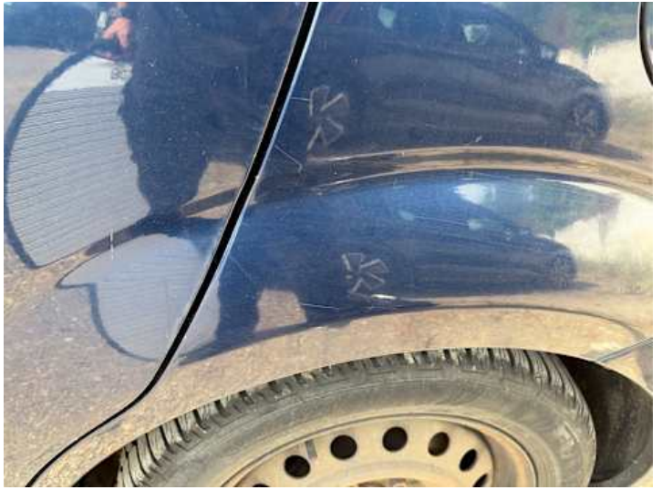
Seitenteil hinten links (Lackschaden, Kratzer)
