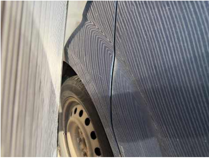
Seitenteil hinten rechts (Delle)
