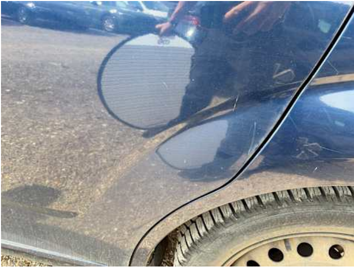
Türe hinten links (Lackschaden, Kratzer)
