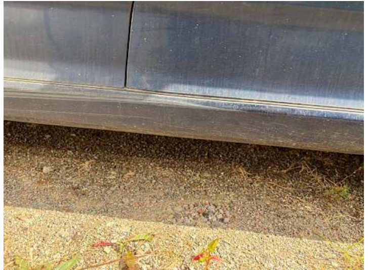
Schweller rechts (Lackschaden, Kratzer)
