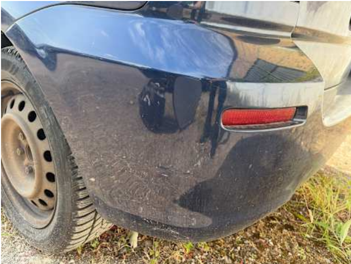
Stoßstange hinten (Lackschaden, Kratzer)
