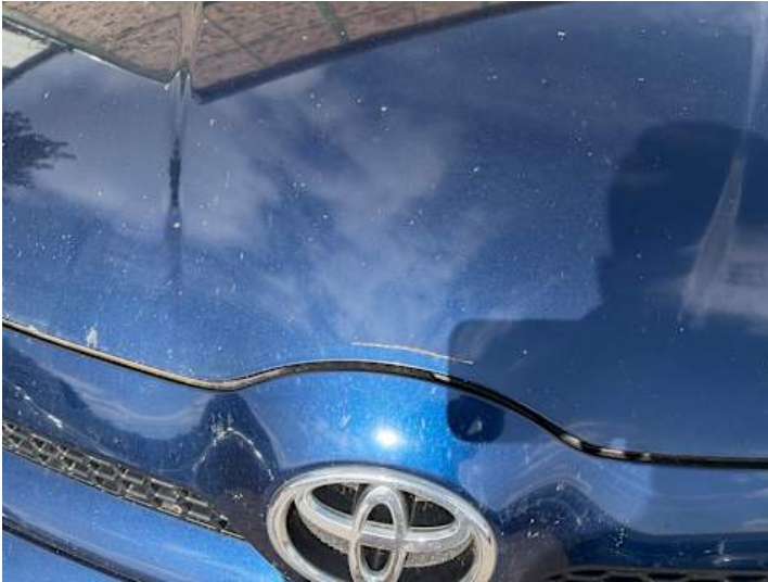
Motorhaube (Lackschaden, Kratzer, Rost)
