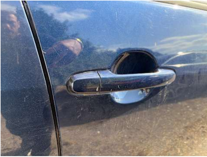
Beifahrertür (Lackschaden, Kratzer)
