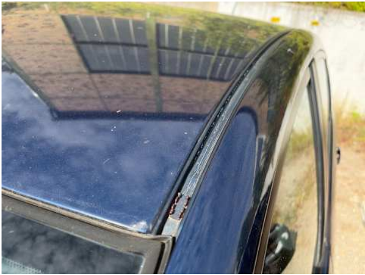
Dach (Anderer Schaden): Leisten fehlen
