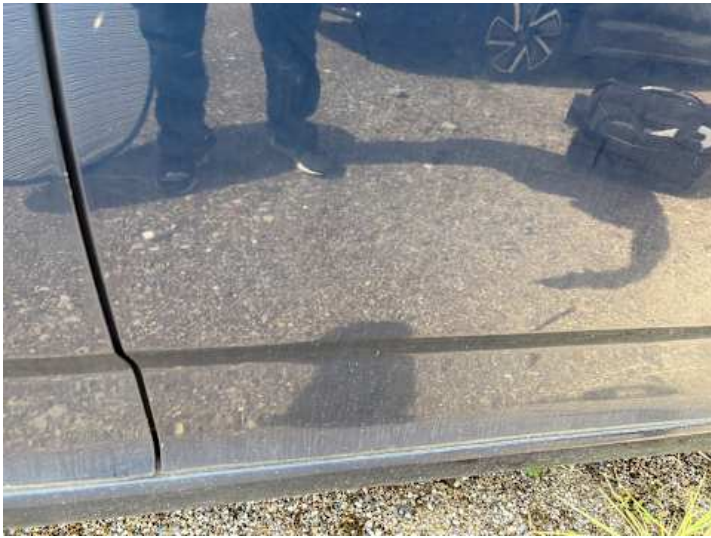
Türe hinten links (Lackschaden, Kratzer)
