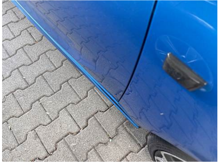
Schweller rechts (Spaltmaße ungenau)
