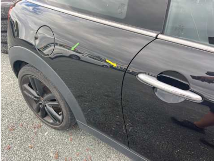
Seitenteil hinten rechts (Lackschaden, Delle)
