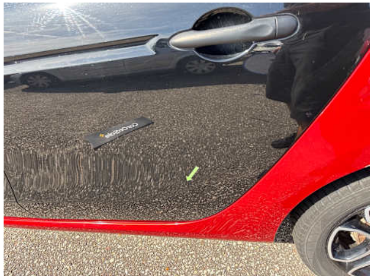
Türe hinten links (Delle, Kratzer)
