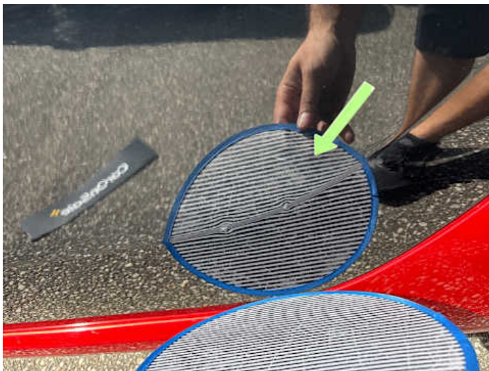
Türe hinten links (Delle, Kratzer)
