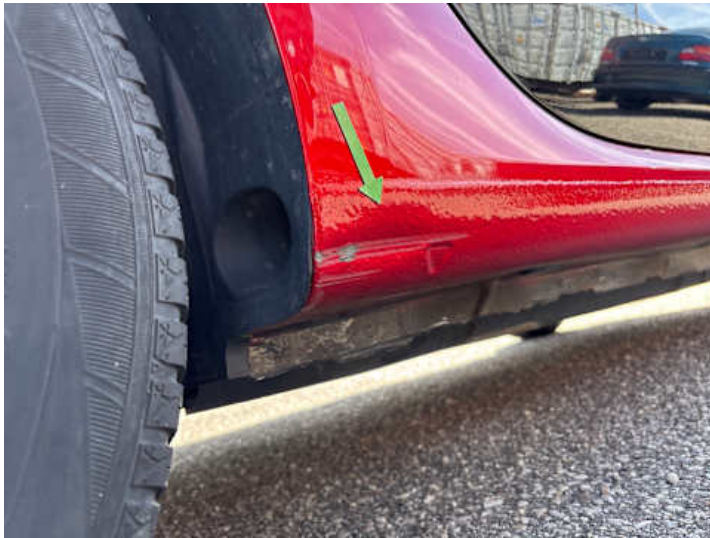
Schweller rechts (Kratzer, Verformung)
