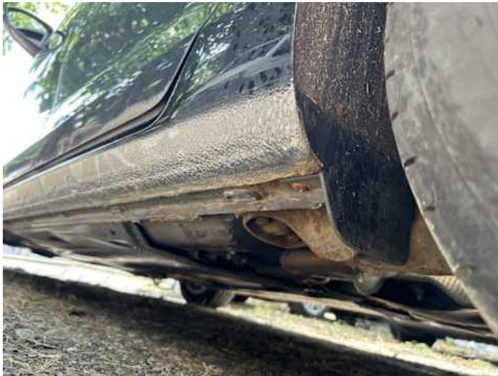
Schweller links (Rost, Unsachgemäß instand gesetzt)
