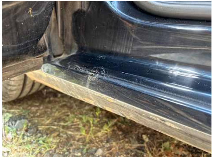
Schweller links (Kratzer, Rost)
