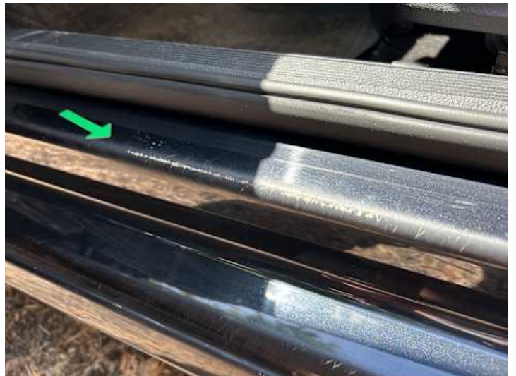
Schweller links (Kratzer, Rost)
