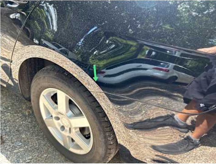
Seitenteil hinten links (Rost)
