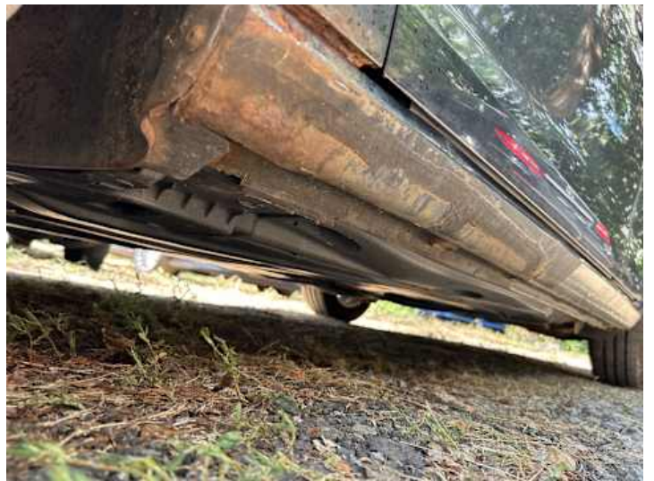
Schweller links (Rost, Unsachgemäß instand gesetzt)
