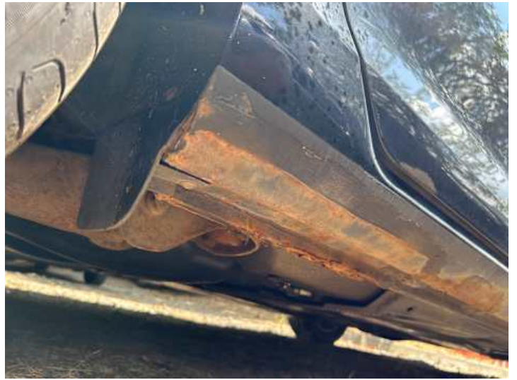
Schweller rechts (Rost, Unsachgemäß instand gesetzt)
