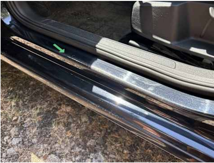
Schweller links (Kratzer, Rost)
