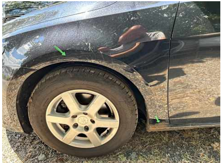
Kotflügel vorne links (Rost)
