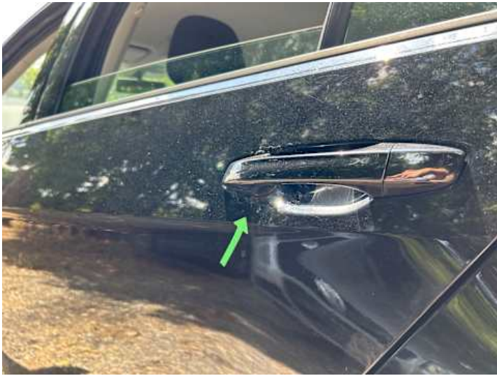
Türe hinten links (Rost)
