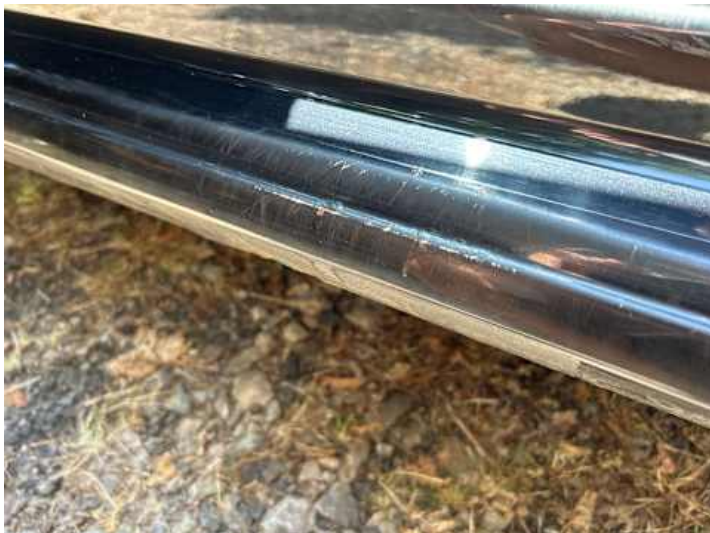
Schweller links (Kratzer, Rost)
