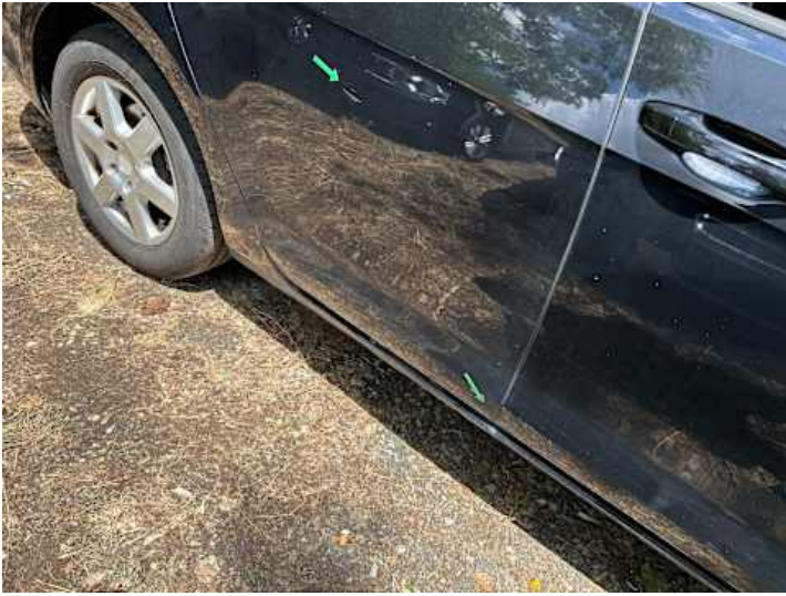
Türe hinten rechts (Rost, Kratzer)
