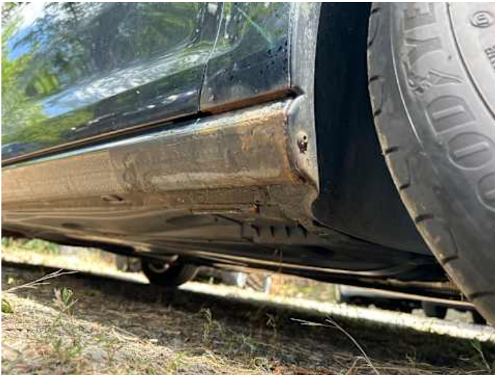
Schweller rechts (Rost, Unsachgemäß instand gesetzt)
