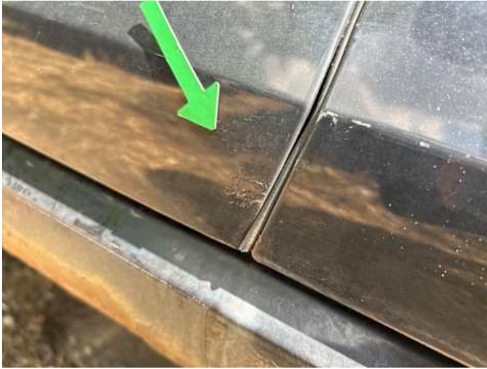
Türe hinten rechts (Rost, Kratzer)
