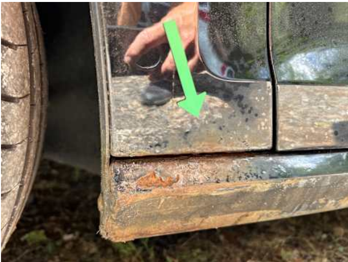
Kotflügel vorne links (Rost)
