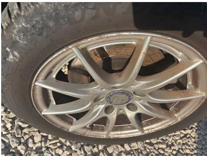
Rad (Kratzer, Kerben, Rost)
