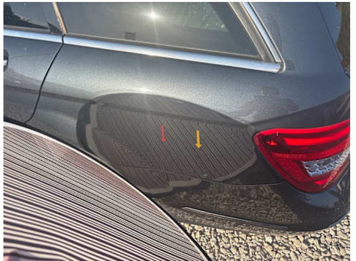
Seitenteil hinten links (Delle, Unsachgemäß instand gesetzt)
