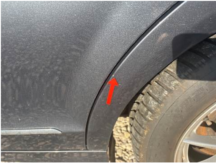
Seitenteil hinten links (Rost, Lackschaden)
