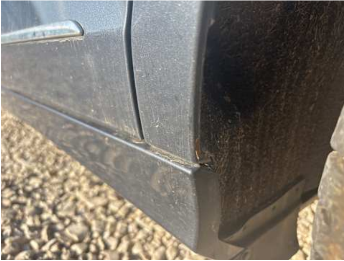
Seitenteil hinten links (Rost, Lackschaden)
