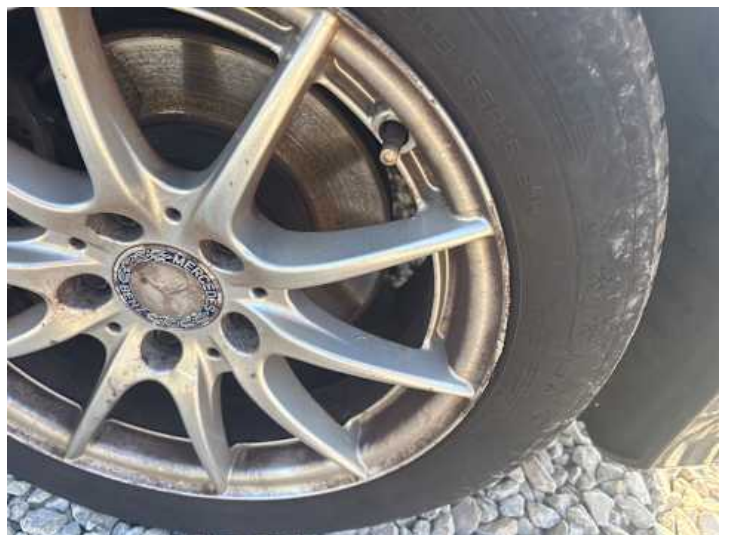
Rad (Kratzer, Kerben, Rost)
