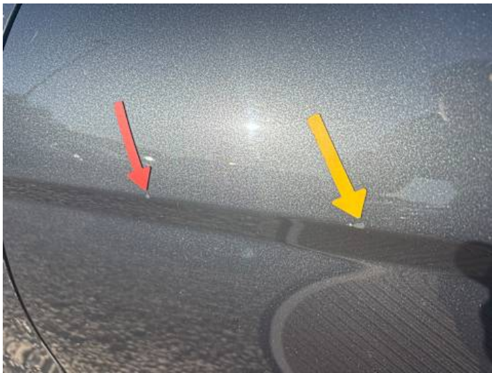
Türe hinten links (Lackschaden)
