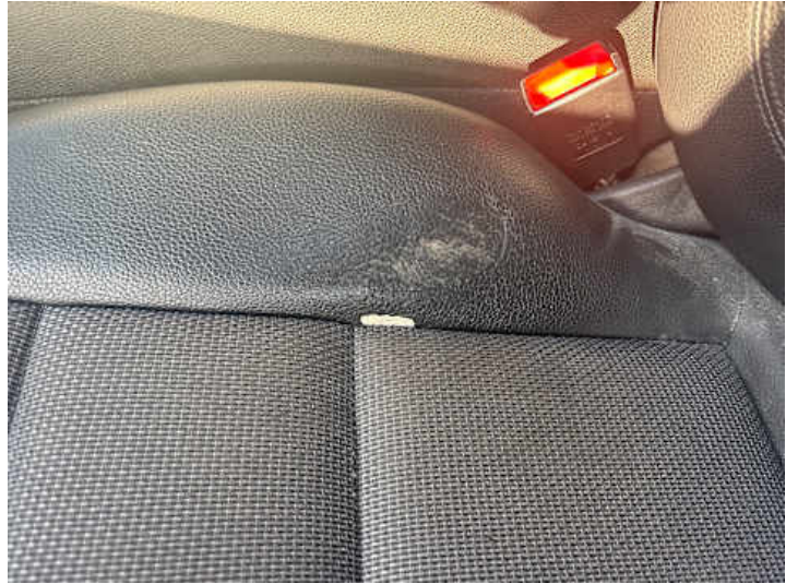
Innenraum (Verschleiß, Riss/Bruch)
