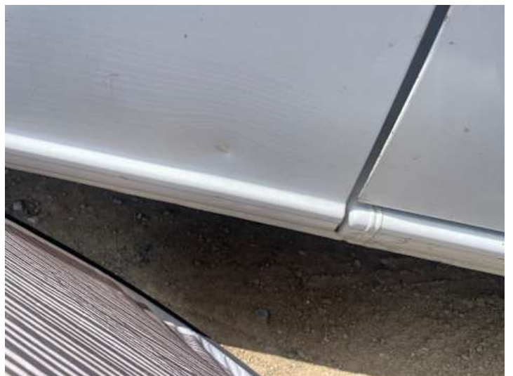
Türe hinten rechts (Verformung)
