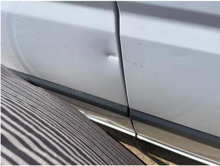
Türe hinten rechts (Verformung)
