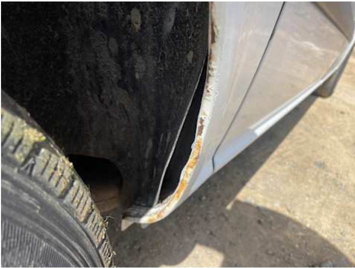
Seitenteil hinten rechts (Rost)
