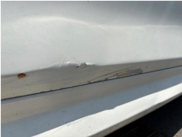
Beifahrertür (Lackschaden, Riss/Bruch)
