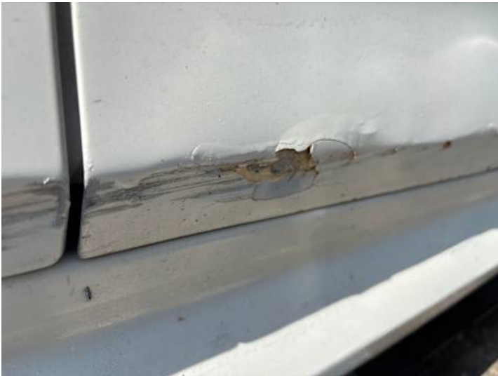
Beifahrertür (Lackschaden, Riss/Bruch)
