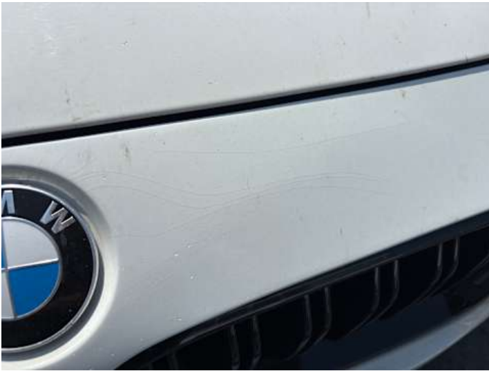
Stoßstange vorne (Lackschaden)
