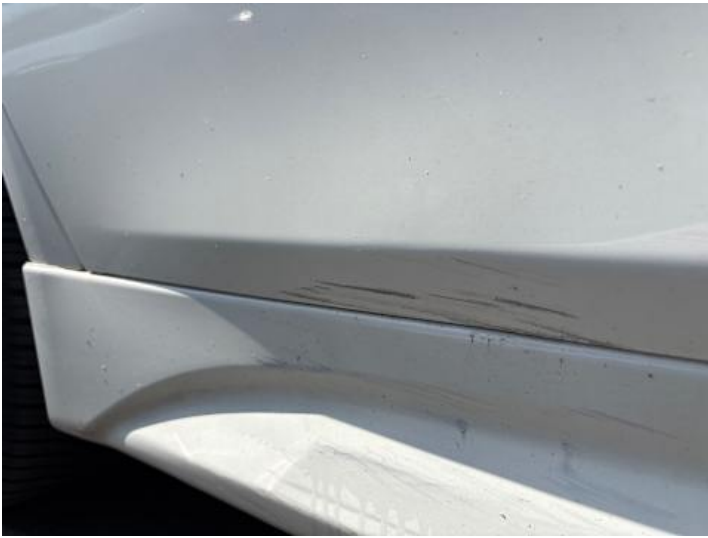
Türe hinten rechts (Kratzer, Verformung)
