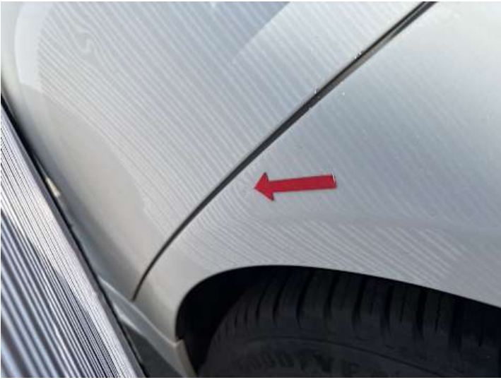
Seitenteil hinten links (Delle)
