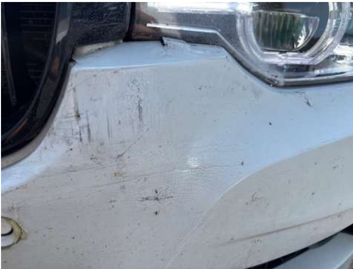
Stoßstange vorne (Lackschaden)
