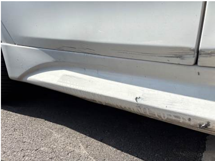
Türe hinten rechts (Kratzer, Verformung)
