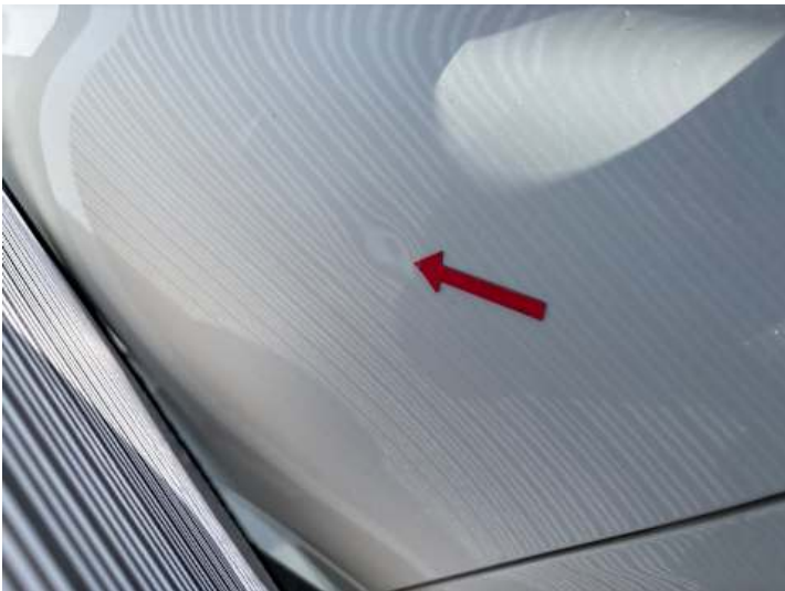
Türe hinten links (Delle)
