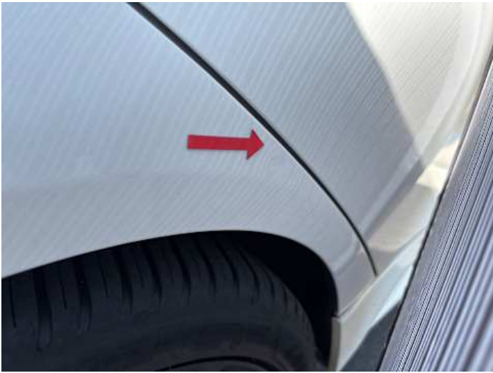
Seitenteil hinten rechts (Delle)
