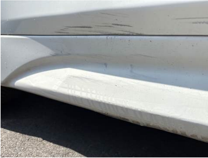
Schweller rechts (Kratzer, Lackschaden)
