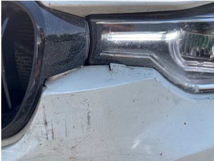
Stoßstange vorne (Riss/Bruch)
