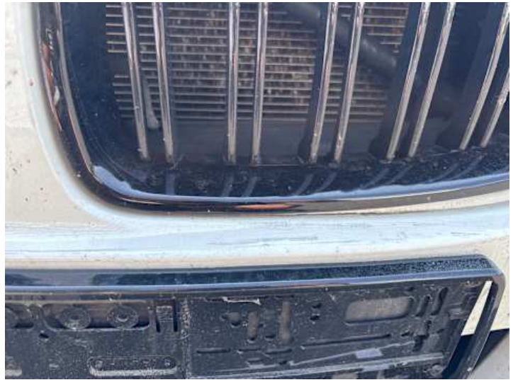
Stoßstange vorne (Lackschaden)
