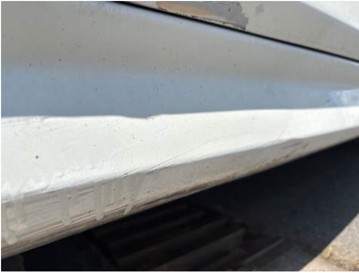
Schweller rechts (Kratzer, Lackschaden)
