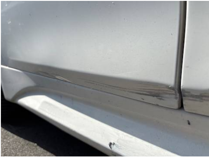
Türe hinten rechts (Kratzer, Verformung)
