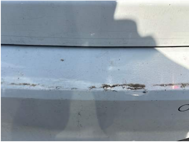
Stoßstange hinten (Kratzer)
