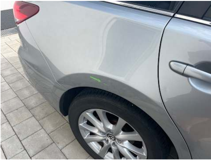
Seitenteil hinten rechts (Lackschaden, Kratzer)
