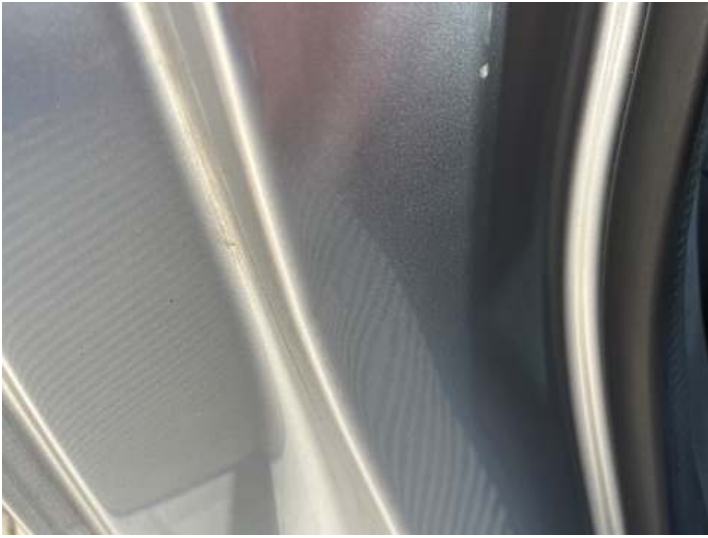
Seitenteil hinten rechts (Delle)
