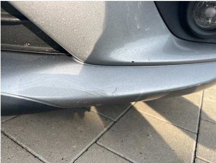
Stoßstange vorne (Lackschaden, Kratzer)
