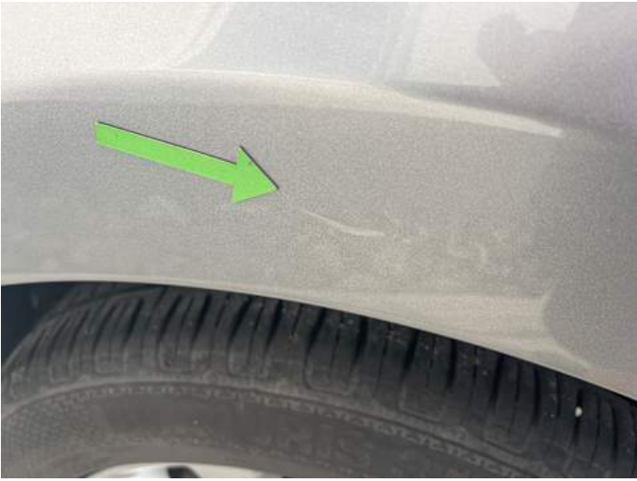
Seitenteil hinten rechts (Lackschaden, Kratzer)
