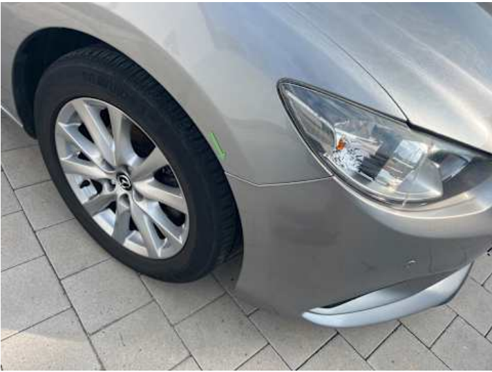
Kotflügel vorne rechts (Lackschaden, Kratzer)
