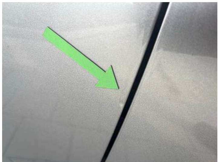
Beifahrertür (Anderer Schaden): Lackläufer
