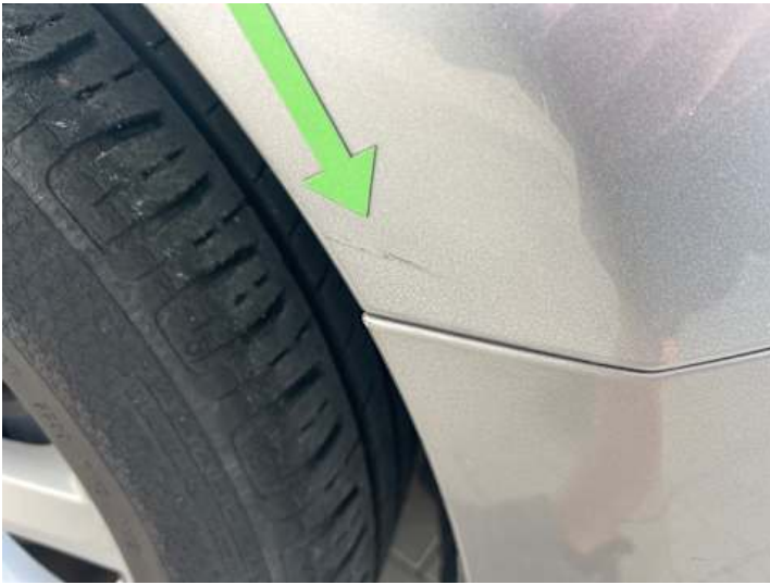
Kotflügel vorne rechts (Lackschaden, Kratzer)
