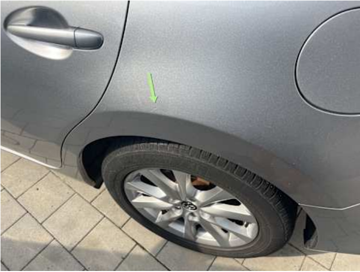
Seitenteil hinten links (Lackschaden, Kratzer)
