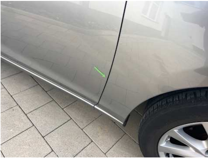
Beifahrertür (Anderer Schaden): Lackläufer
