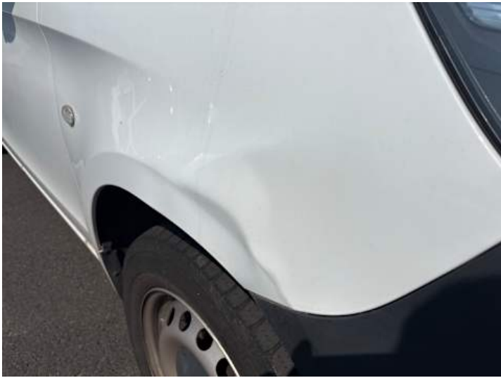
Kotflügel vorne rechts (Kratzer, Delle)
