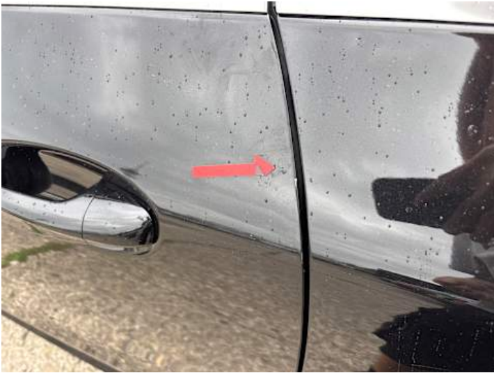
Fahrtür (Kratzer, Delle)
