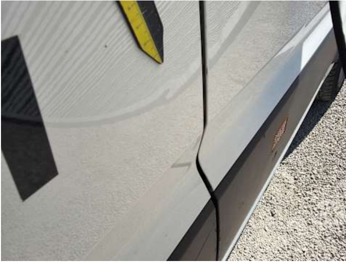
Türe hinten rechts (Kratzer, Lackschaden, Delle)
