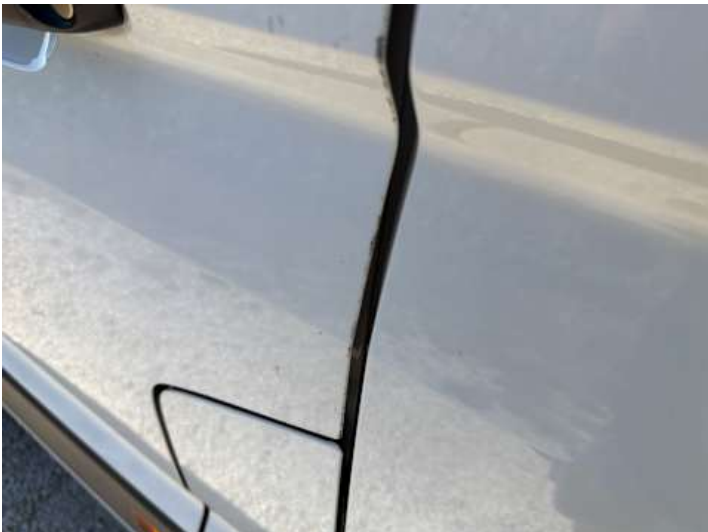
Fahrtür (Lackschaden, Kratzer)
