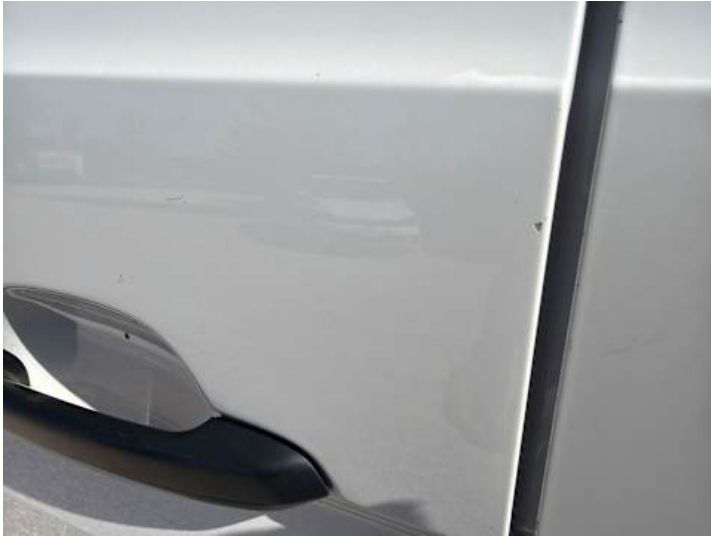
Türe hinten rechts (Kratzer, Lackschaden, Delle)
