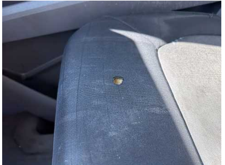
Innenraum (Verschmutzung, Verschleiß, Kratzer, Riss/Bruch, Brandloch)
