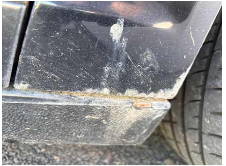
Kotflügel vorne rechts (Rost, Lackschaden)
