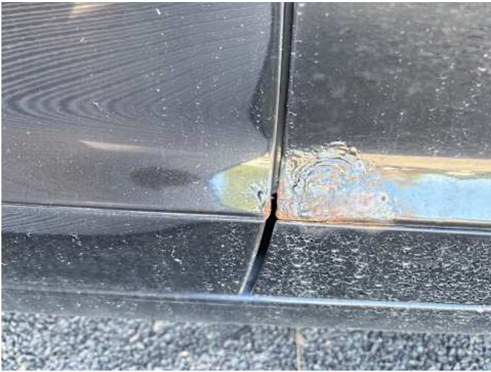
Türe hinten rechts (Rost)
