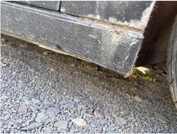
Schweller rechts (Rost)
