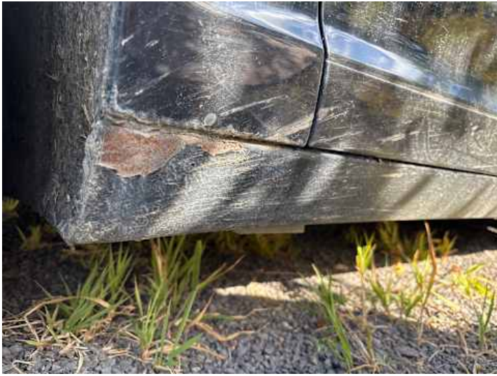
Schweller links (Rost)
