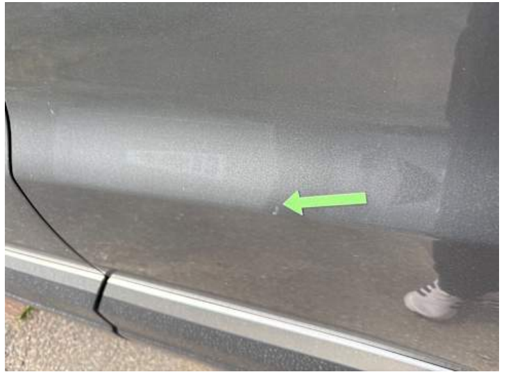
Türe hinten links (Kratzer)
