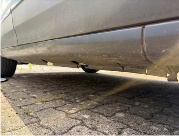
Schweller rechts (Kratzer, Verformung)
