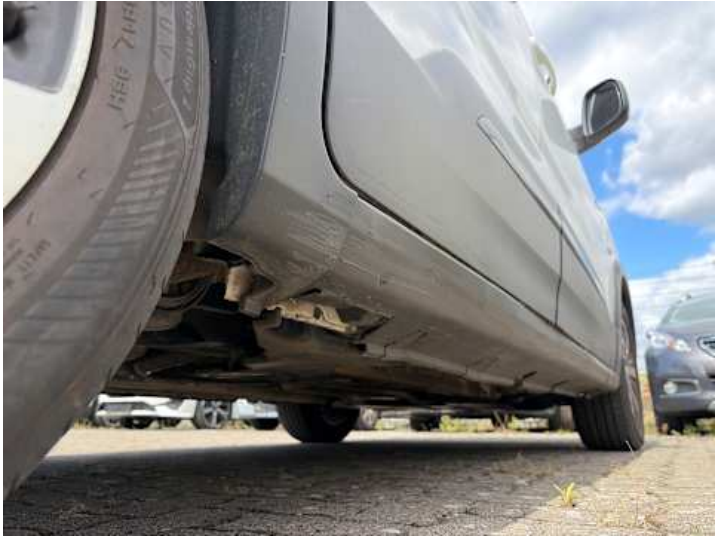
Schweller rechts (Kratzer, Verformung)
