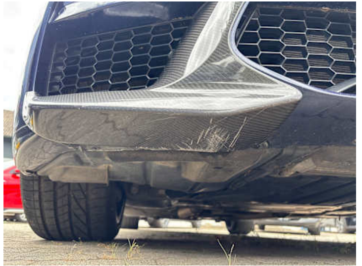
Stoßstange vorne (Lackschaden, Kratzer)
