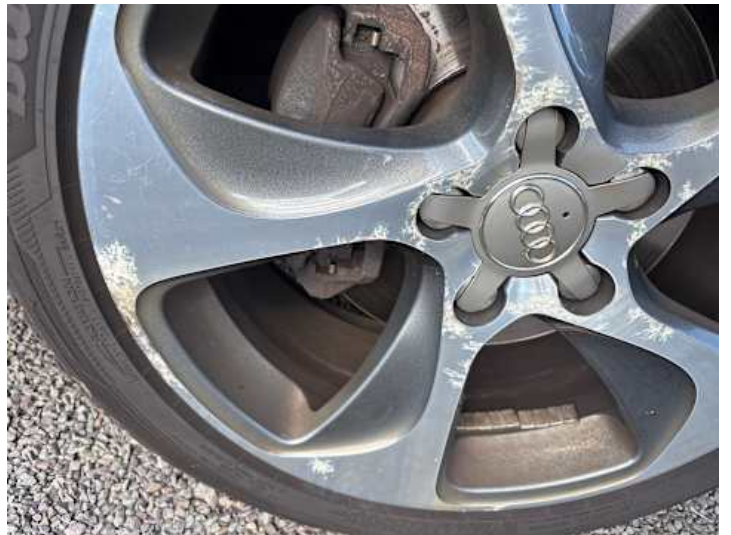
Rad (Kratzer, Kerben, Rost)
