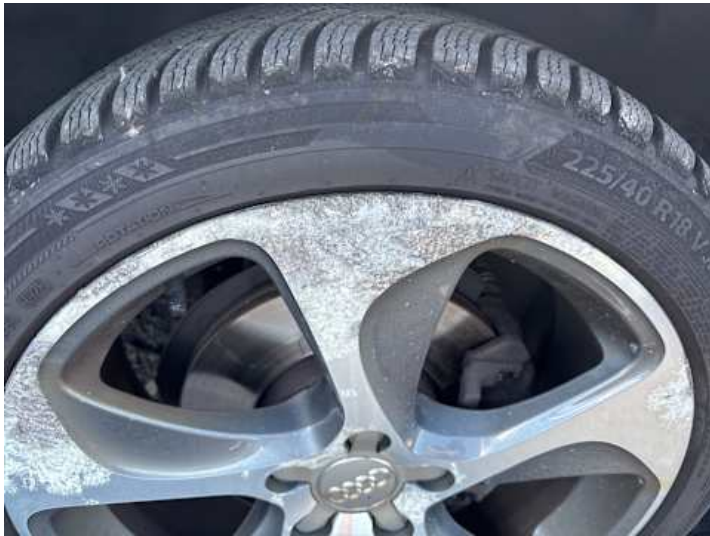
Rad (Kratzer, Kerben, Rost)
