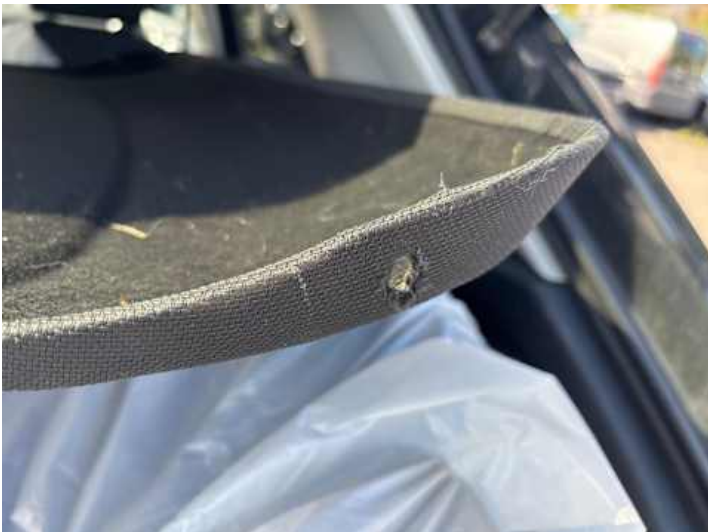
Innenraum (Anderer Schaden): Hutablage Befestigung defekt
