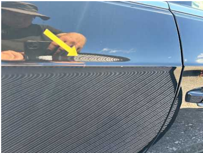
Türe hinten rechts (Lackschaden, Delle)
