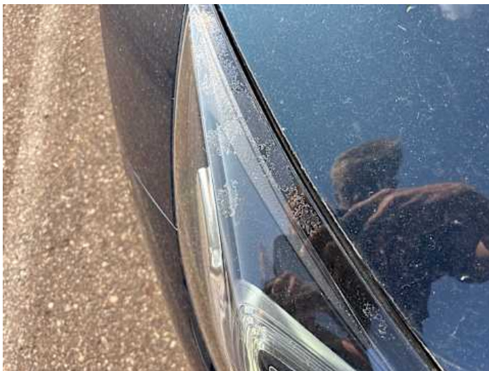
Scheinwerfer (rechts) (Anderer Schaden): Folie beschädigt
