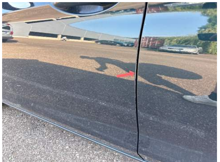
Fahrtür (Delle, Kratzer)
