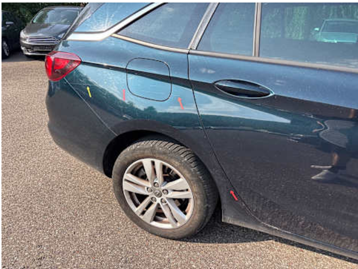
Seitenteil hinten rechts (Kratzer)
