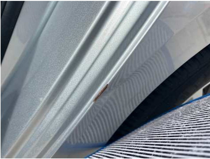
Seitenteil hinten links (Lackschaden, Rost, Delle)
