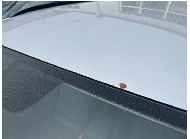
Dach (Lackschaden, Rost)
