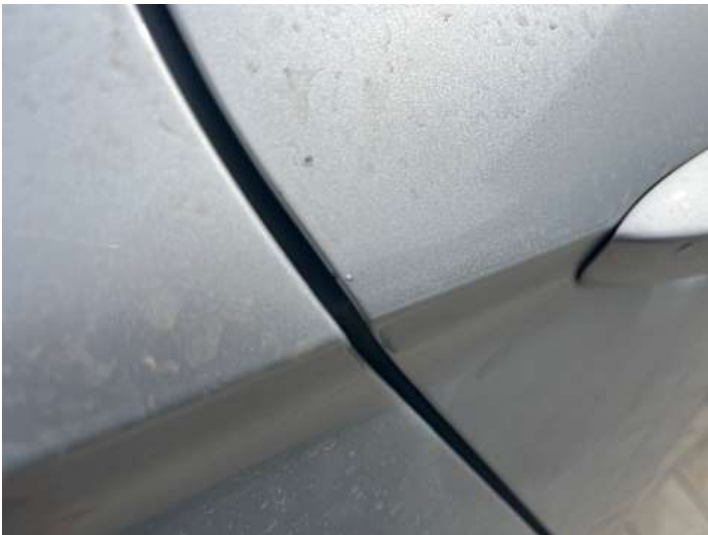
Türe hinten rechts (Lackschaden, Rost)
