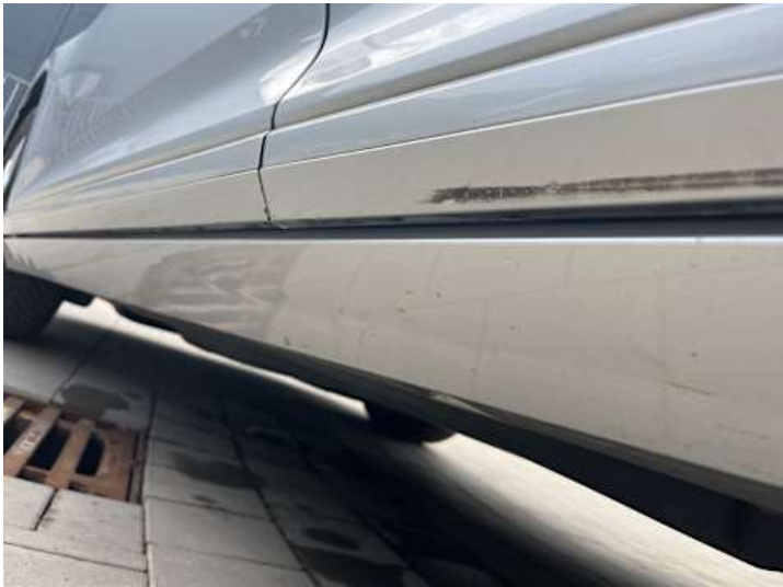
Schweller links (Lackschaden, Verformung)
