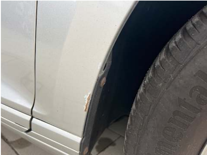
Kotflügel vorne rechts (Lackschaden, Rost)
