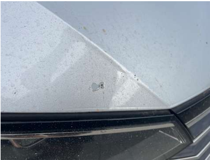
Motorhaube (Lackschaden, Steinschlag, Rost)
