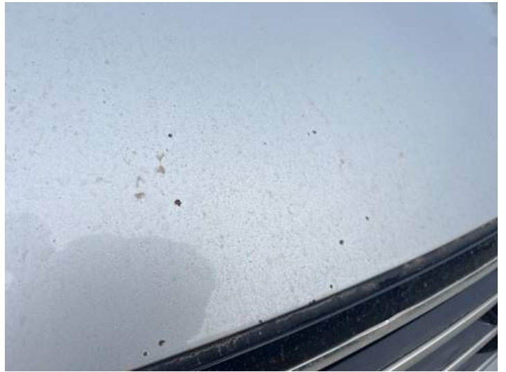
Motorhaube (Lackschaden, Steinschlag, Rost)
