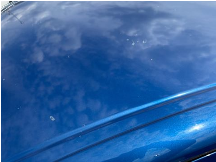
Dach (Lackschaden, Kratzer)
