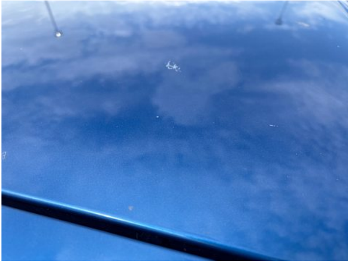
Dach (Lackschaden, Kratzer)
