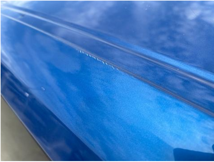
Dach (Lackschaden, Kratzer)
