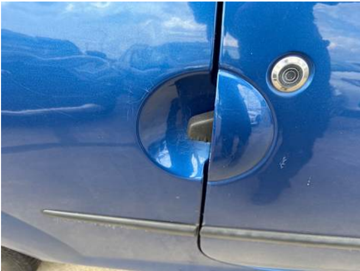
Seitenteil hinten rechts (Kratzer)
