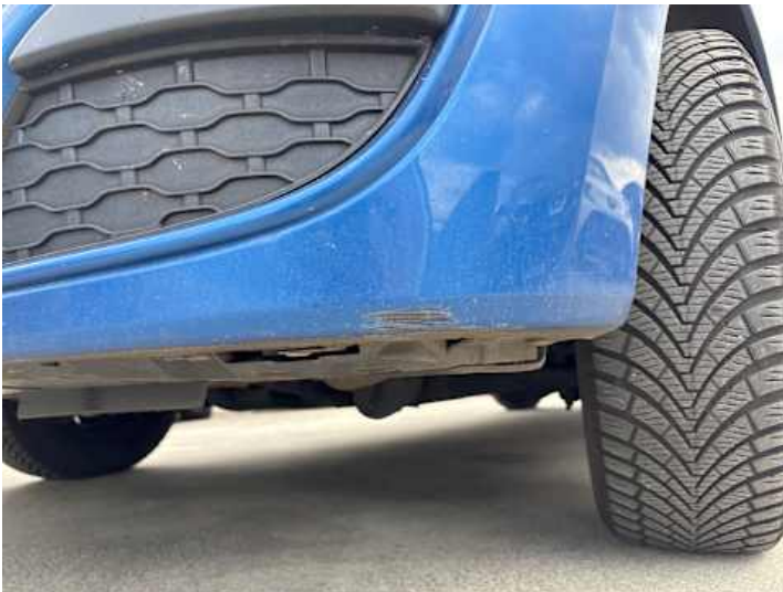
Stoßstange vorne (Kratzer, Unsachgemäß instand gesetzt)
