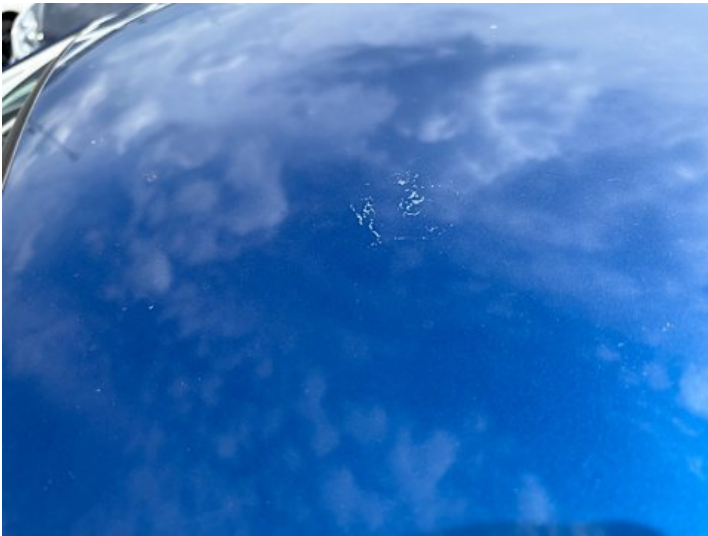
Dach (Lackschaden, Kratzer)
