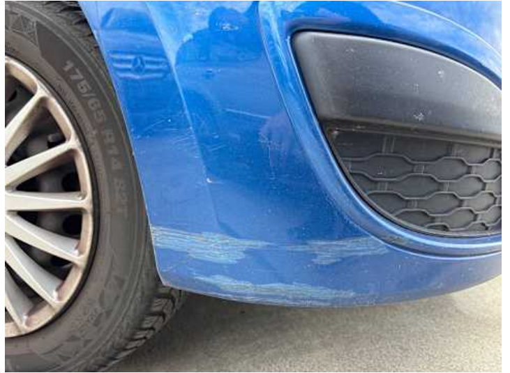
Stoßstange vorne (Kratzer, Unsachgemäß instand gesetzt)
