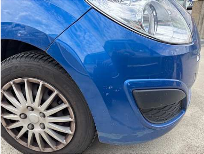
Stoßstange vorne (Kratzer, Unsachgemäß instand gesetzt)
