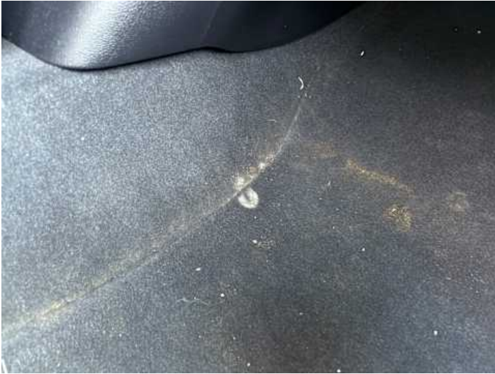
Innenraum (Tierhaare/Tiergeruch, Anderer Schaden): Schimmel;
