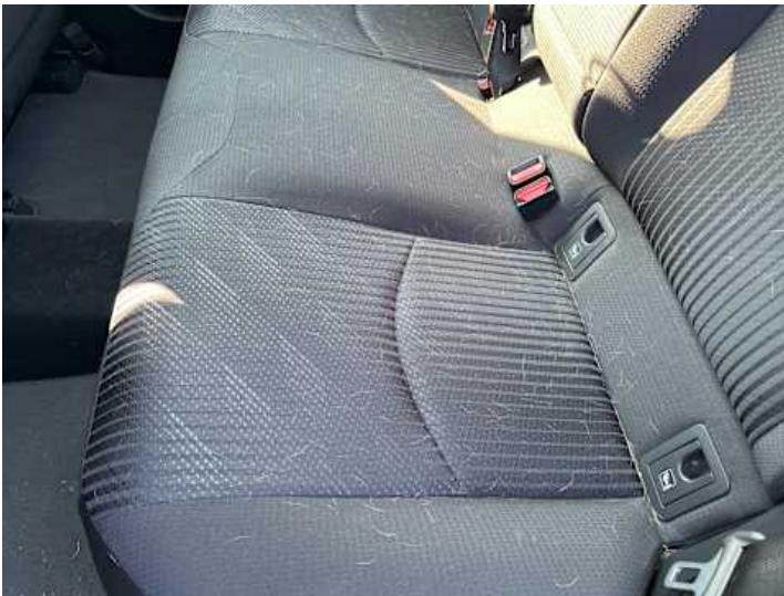
Innenraum (Tierhaare/Tiergeruch, Anderer Schaden): Schimmel;
