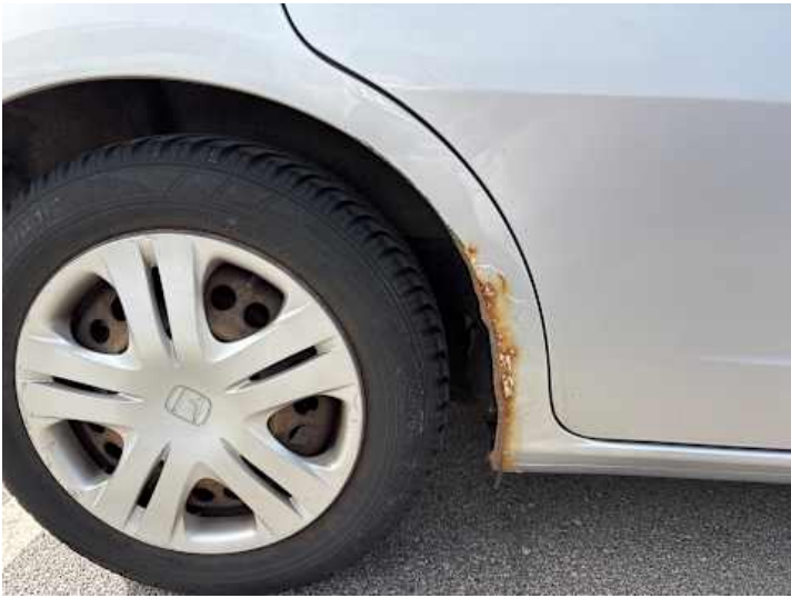
Seitenteil hinten rechts (Rost)
