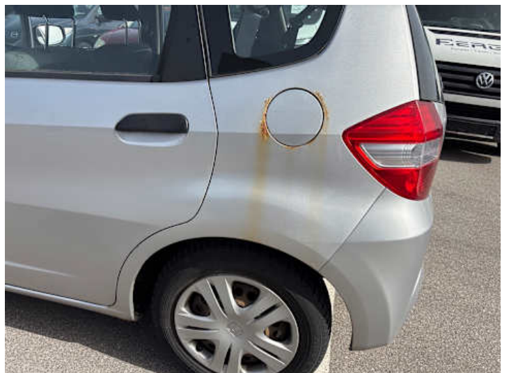
Seitenteil hinten links (Rost)
