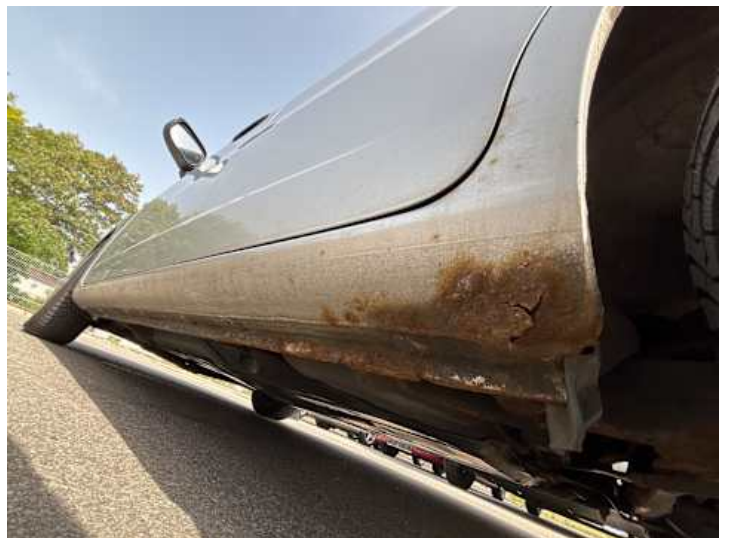
Schweller links (Rost)
