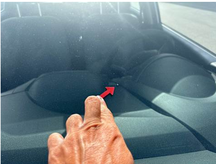
Windschutzscheibe (Steinschlag, Riss/Bruch)
