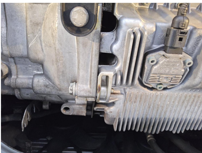
Motor - Ölundichtigkeit / prüfen
