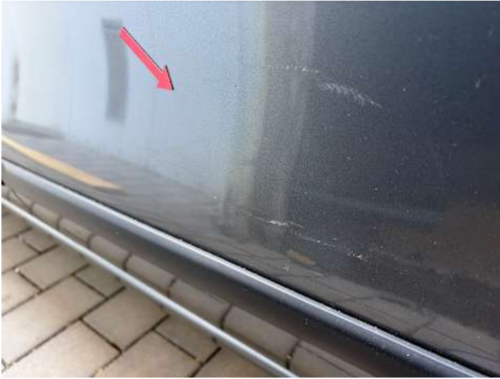
Türe hinten links (Kratzer, Delle)
