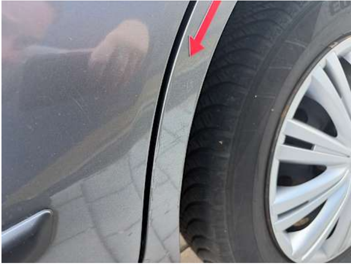
Seitenteil hinten links (Kratzer, Delle)
