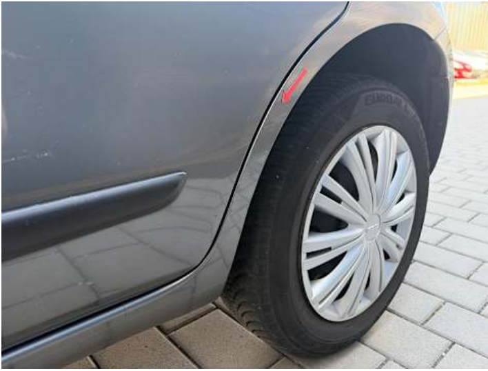
Seitenteil hinten links (Kratzer, Delle)
