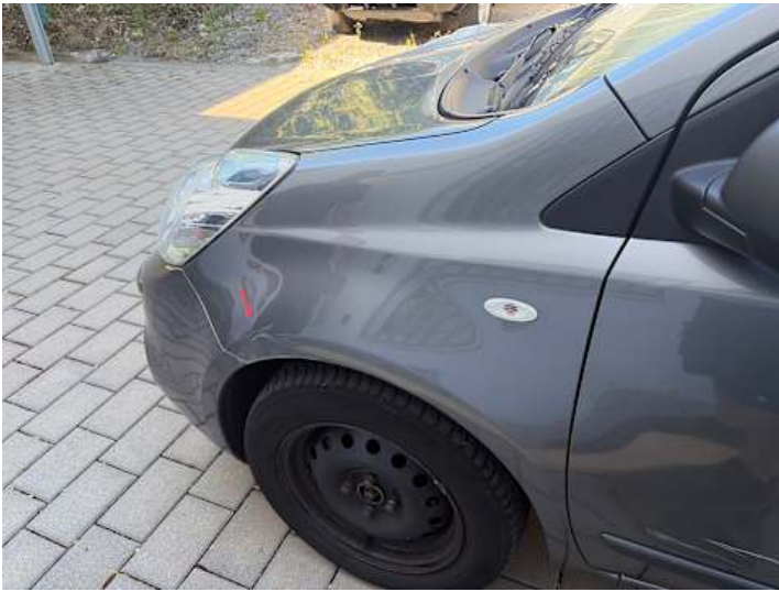
Kotflügel vorne links (Kratzer, Delle)
