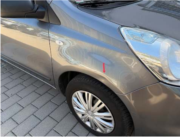
Kotflügel vorne rechts (Delle)
