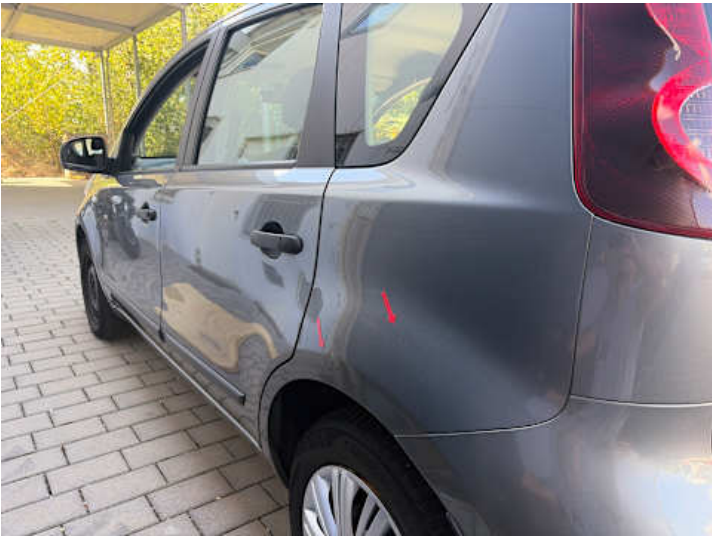
Seitenteil hinten links (Kratzer, Delle)
