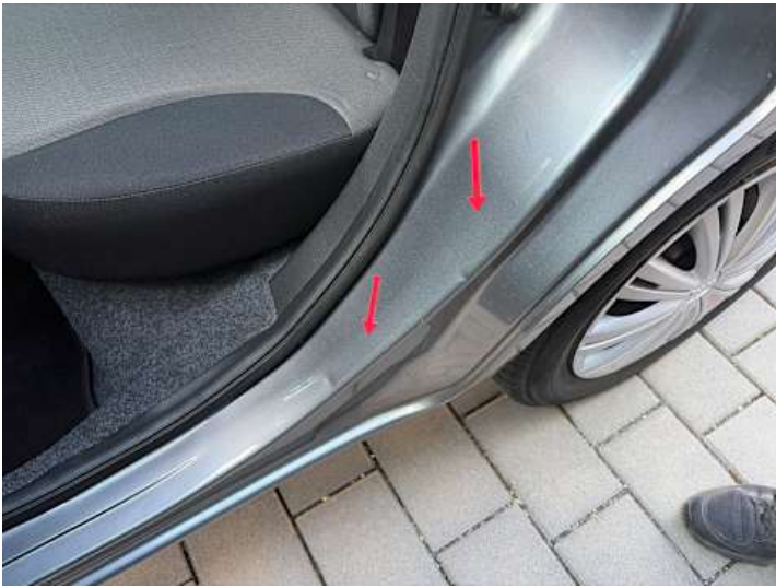
Türe hinten links (Kratzer, Delle)
