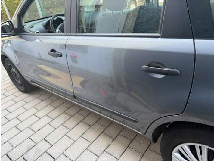
Türe hinten links (Kratzer, Delle)
