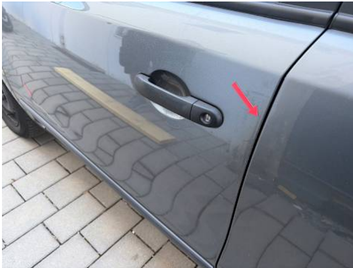
Fahrtür (Kratzer, Delle)
