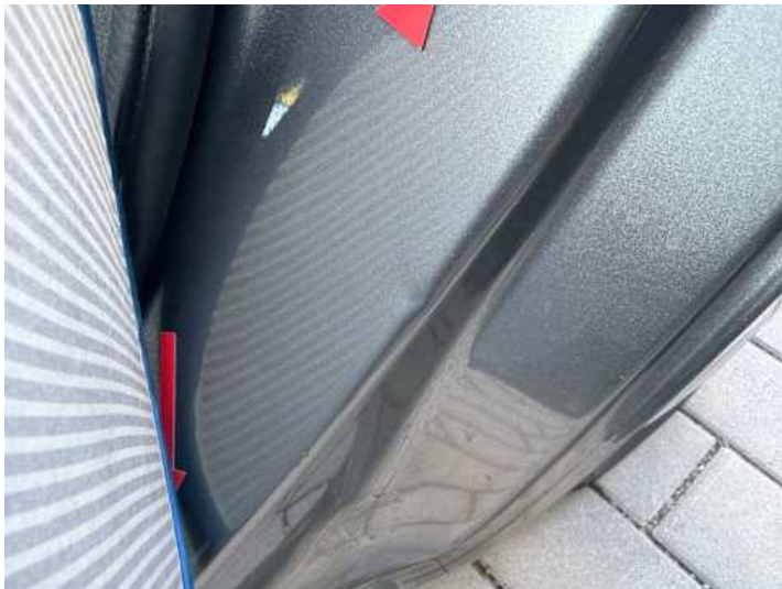
Türe hinten links (Kratzer, Delle)
