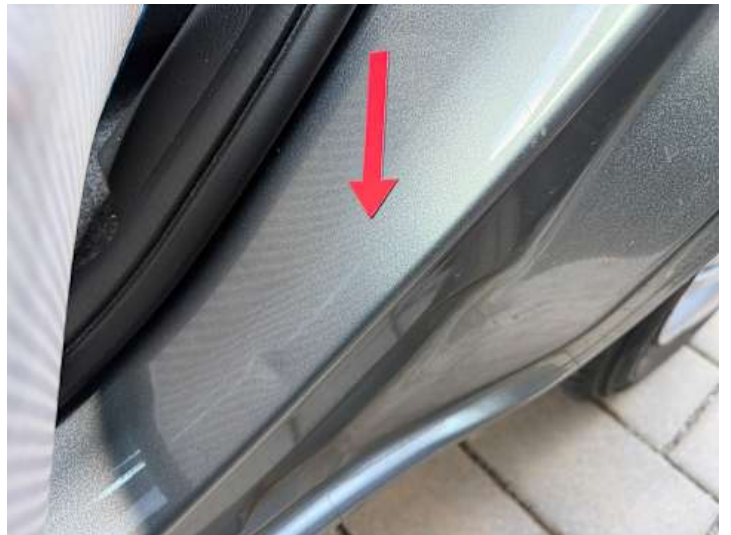
Türe hinten links (Kratzer, Delle)
