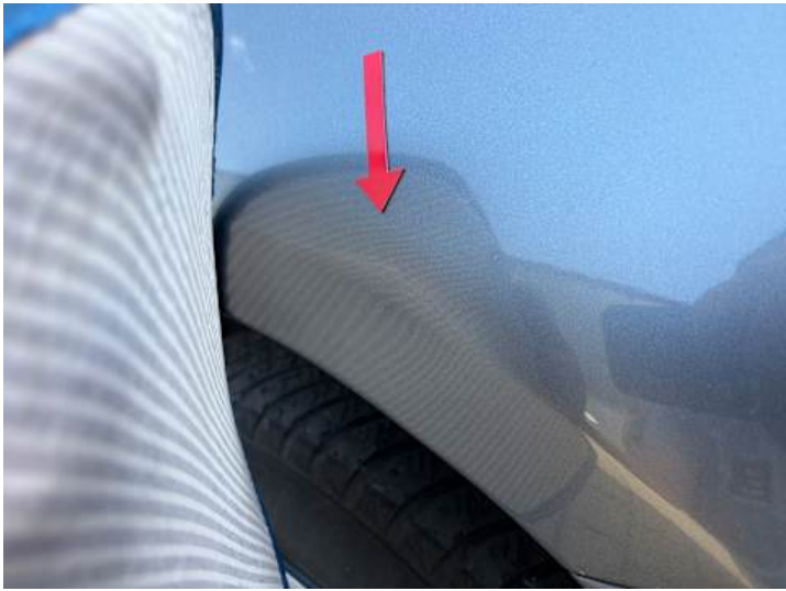
Kotflügel vorne rechts (Delle)
