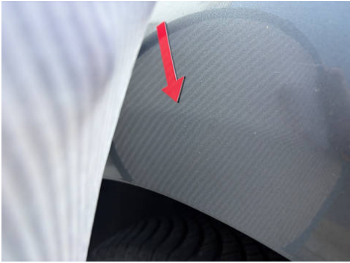
Seitenteil hinten links (Kratzer, Delle)
