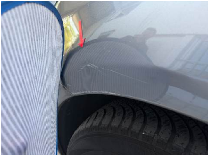
Kotflügel vorne links (Kratzer, Delle)
