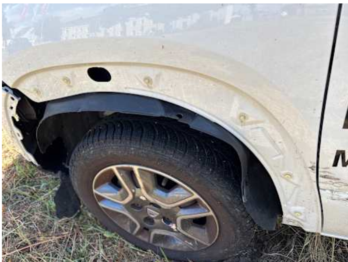
Kotflügel vorne links (Riss/Bruch, Verformung)
