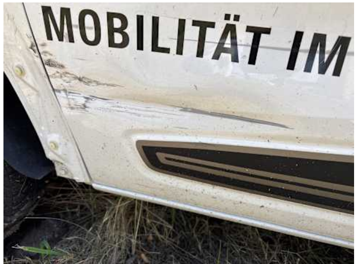
Fahrertür (Verformung, Lackschaden)
