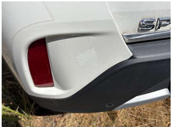
Stoßstange hinten (Lackschaden)
