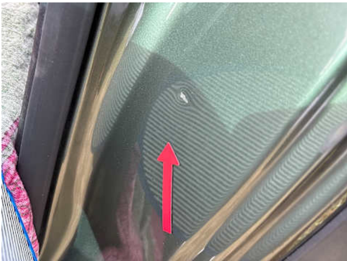
Schweller links (Kratzer, Delle)
