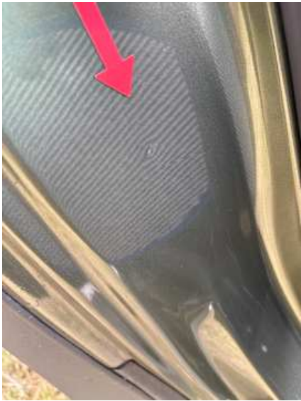
Schweller rechts (Kratzer, Delle)
