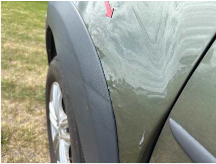
Kotflügel vorne links (Lackschaden, Verformung)
