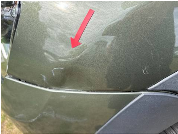
Kotflügel vorne links (Lackschaden, Verformung)
