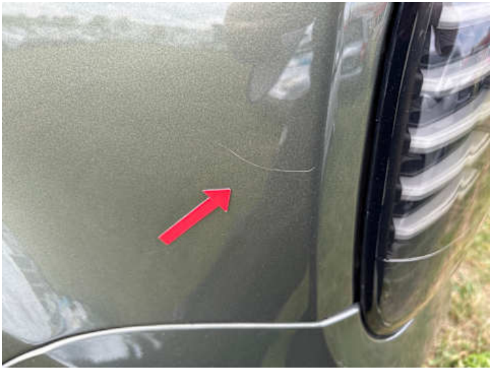
Seitenteil hinten links (Kratzer)
