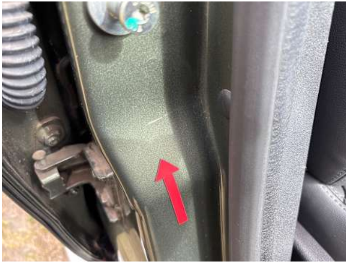
Schweller rechts (Kratzer, Delle)
