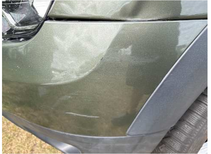
Stoßstange vorne (Kratzer, Lackschaden, Spaltmaße ungenau)
