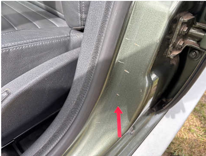
Schweller links (Kratzer, Delle)
