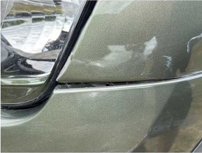
Stoßstange vorne (Kratzer, Lackschaden, Spaltmaße ungenau)
