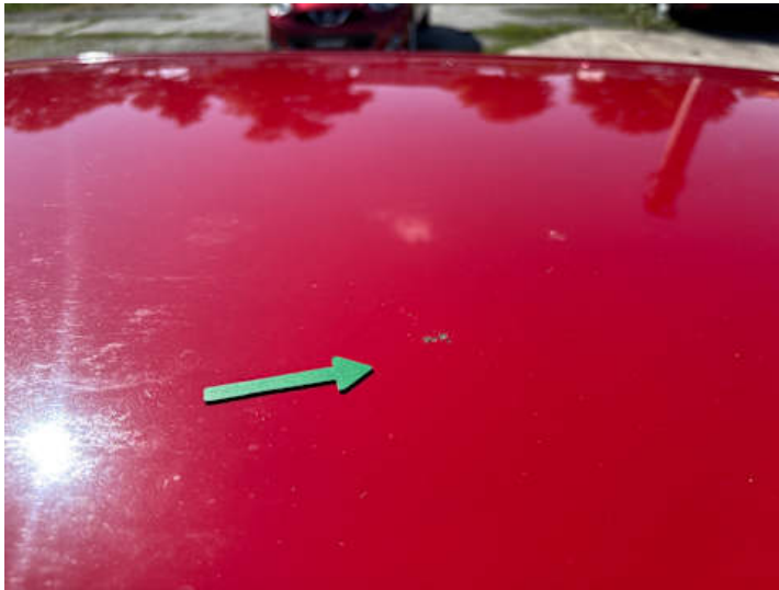
Dach (Lackschaden, Steinschlag)
