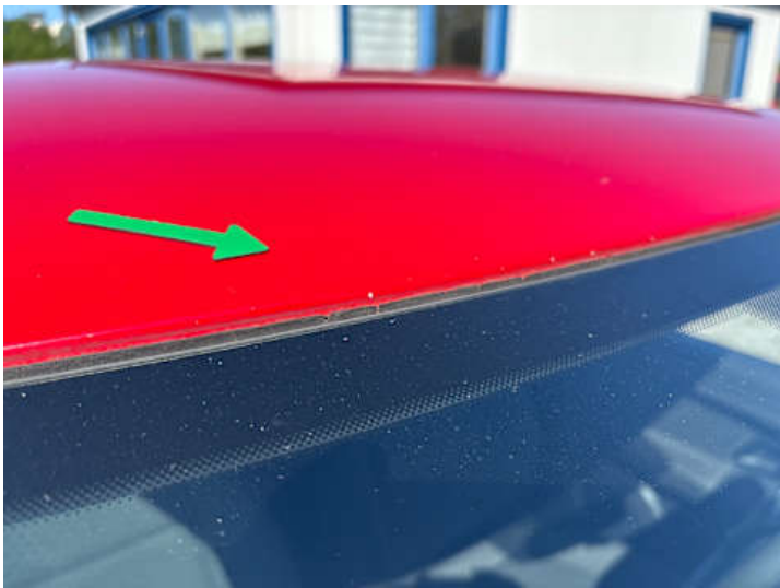
Dach (Lackschaden, Steinschlag)
