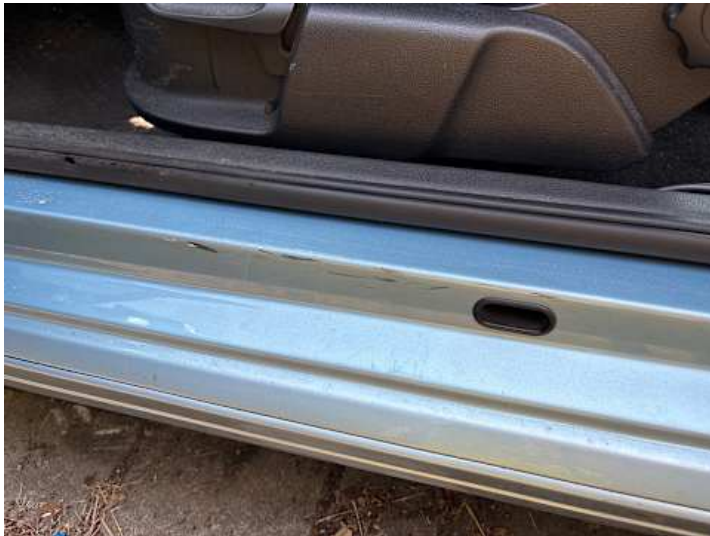
Schweller links (Kratzer)
