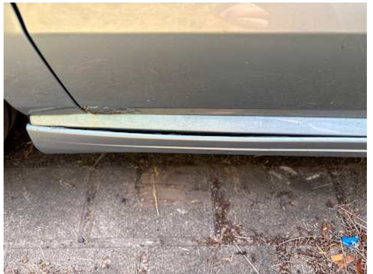
Schweller links (Verformung)
