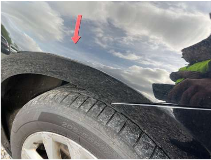
Kotflügel vorne rechts (Lackschaden, Unsachgemäß instand gesetzt)
