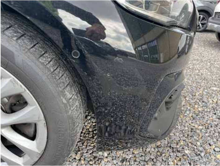
Stoßstange vorne (Lackschaden, Unsachgemäß instand gesetzt)
