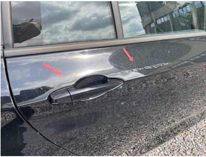
Türe hinten rechts (Lackschaden, Unsachgemäß instand gesetzt)
