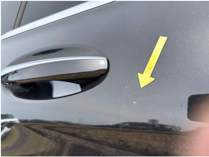
Türe hinten rechts (Rost, Lackschaden)
