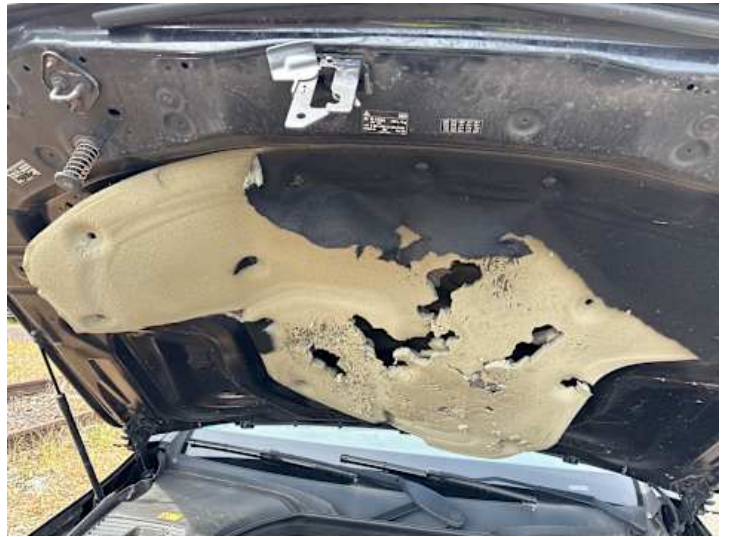
Motorhaube (Anderer Schaden): Dämmmatte beschädigt
