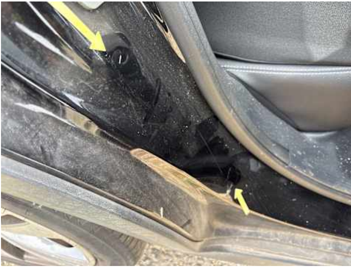
Türe hinten rechts (Lackschaden, Delle)
