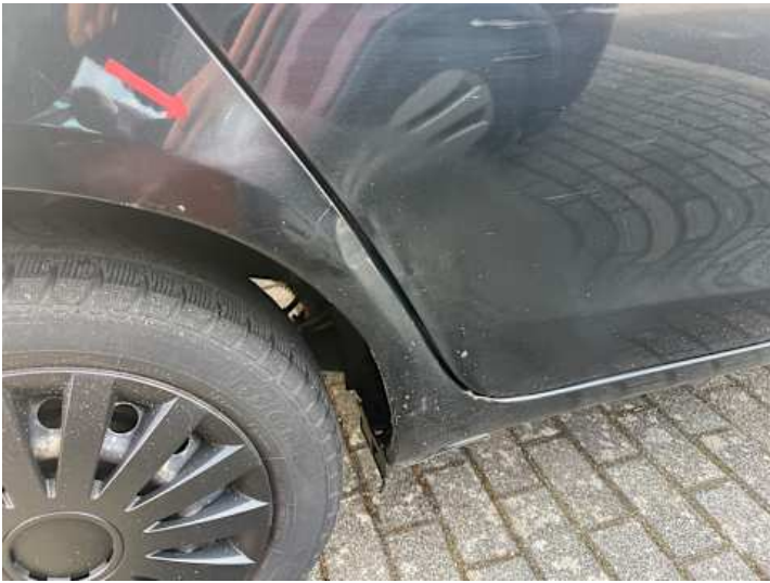
Seitenteil hinten rechts (Unsachgemäß instand gesetzt, Rost, Delle)
