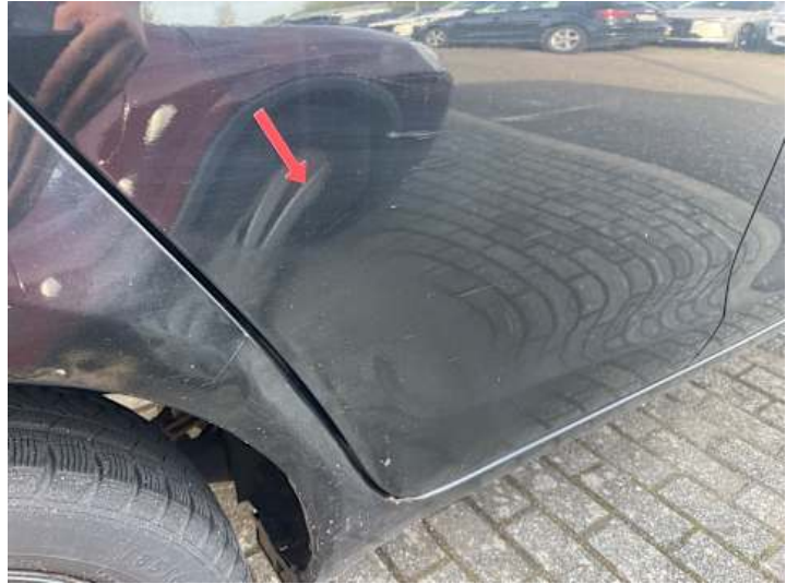
Türe hinten rechts (Unsachgemäß instand gesetzt, Delle, Kratzer)
