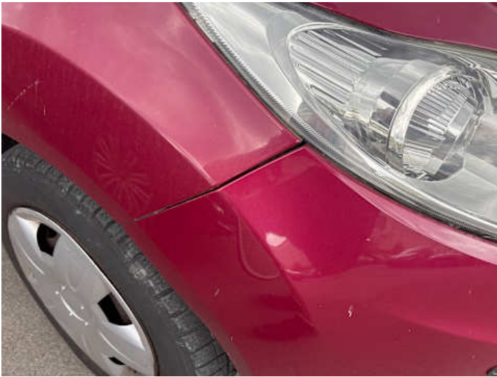
Stoßstange vorne (Spaltmaße ungenau)
