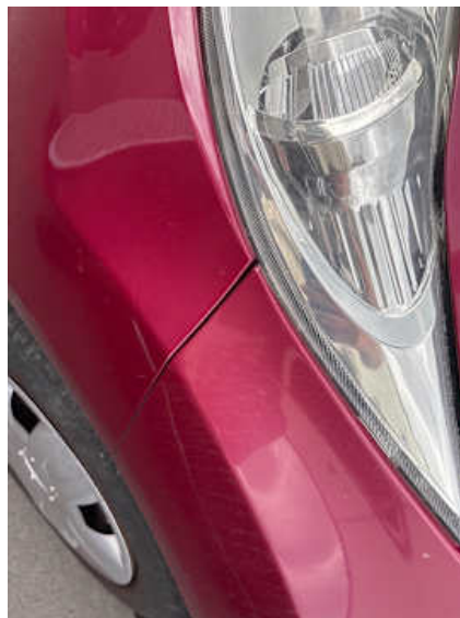
Stoßstange vorne (Spaltmaße ungenau)
