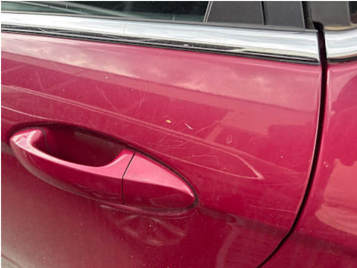
Türe hinten links (Kratzer)
