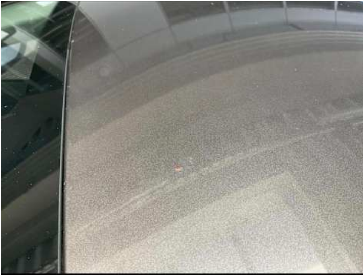
Dach (Rost, Lackschaden)
