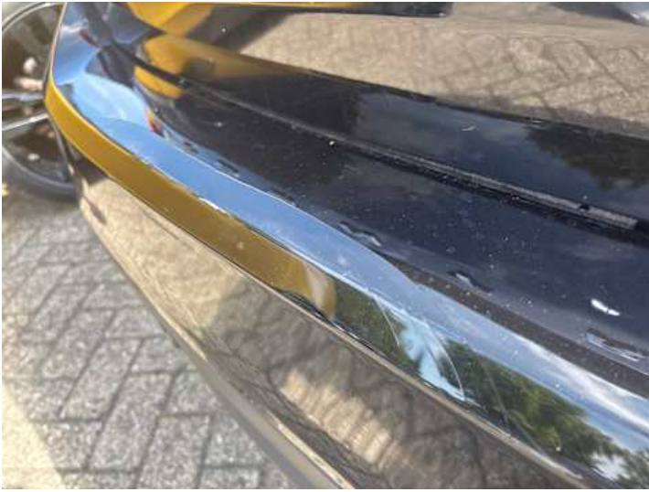
Stoßstange hinten (Verformung, Kratzer)
