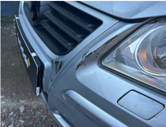
Stoßstange vorne (Spaltmaße ungenau, Lackschaden)
