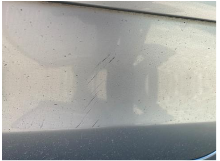
Türe hinten links (Lackschaden)
