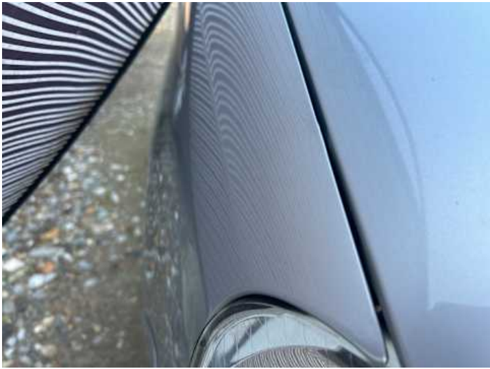
Kotflügel vorne rechts (Verformung, Lackschaden)
