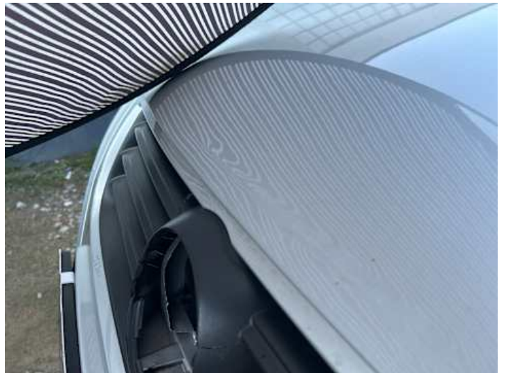
Motorhaube (Verformung, Lackschaden)
