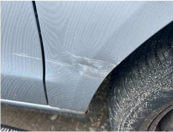
Kotflügel vorne rechts (Verformung, Lackschaden)
