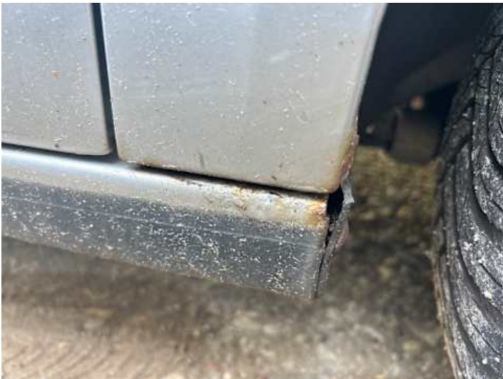
Schweller rechts (Rost)
