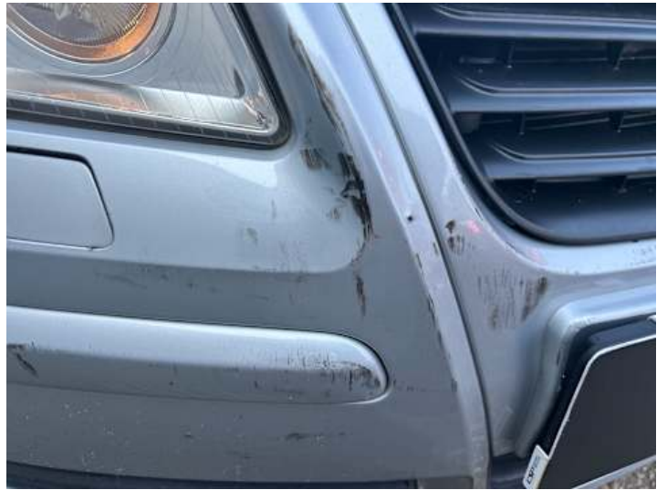
Stoßstange vorne (Spaltmaße ungenau, Lackschaden)
