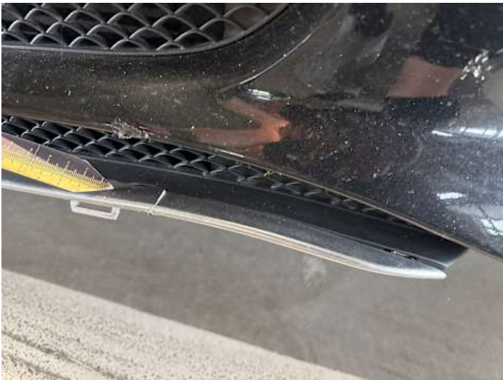
Stoßstange vorne (Lackschaden, Riss/Bruch)
