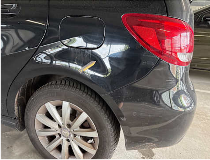
Seitenteil hinten links (Lackschaden)
