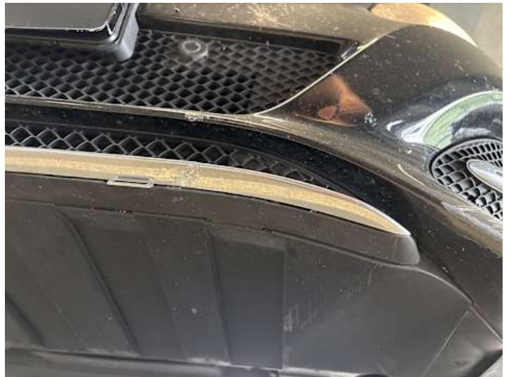
Stoßstange vorne (Lackschaden, Riss/Bruch)
