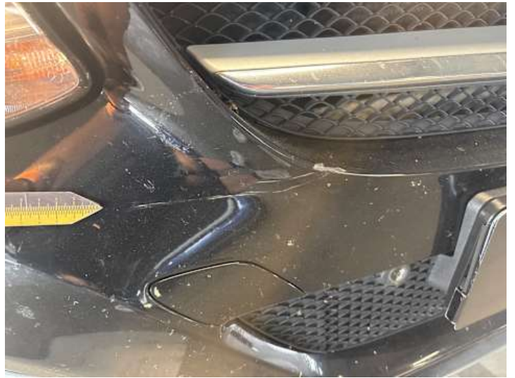
Stoßstange vorne (Lackschaden, Riss/Bruch)
