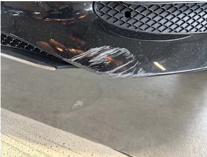
Stoßstange vorne (Lackschaden, Riss/Bruch)
