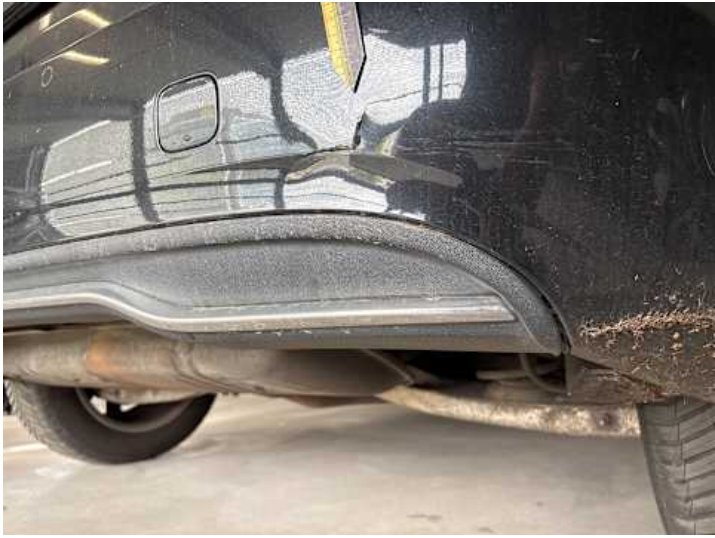
Stoßstange hinten (Riss/Bruch)
