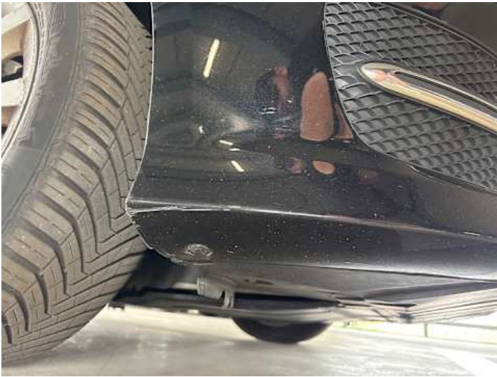
Stoßstange vorne (Lackschaden, Riss/Bruch)
